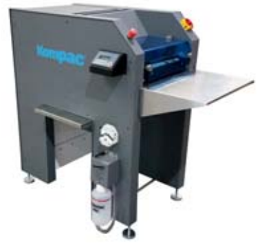
Einstiegsmodell Kompac EZ 15 Plus für wasserbasierten Lack, UV-Lack oder Primerauftrag.
