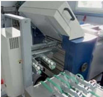
Das Schwertfalzwerk MS 45 kann an verschiedenen Positionen in der Falzanlage eingesetzt werden.
