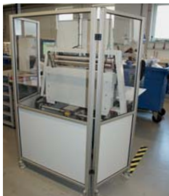
Die Verglasung des Rüttlers ist eine optisch schöne Umsetzung der bestehenden BG-Vorschrift.
