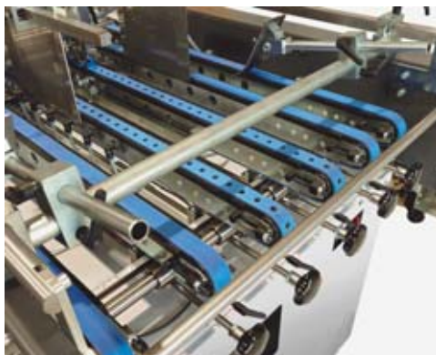
Sorgt für verkürzte Rüstzeiten: die Schnellverstellung am neuen Anleger der ProFold 74.
