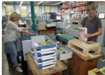
Mit zwei Personen an der KAS Integra von Kern ist die Beilagen-Zugabe auch für eine hohe Auflage dank Niveau-, Fehl- und Doppelblattkontrolle schnell und unproblematisch erledigt.
