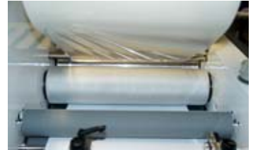
Die Prägeeinrichtung presst verschiedene Oberflächen mit großem Druck in die Laminierfolie.
