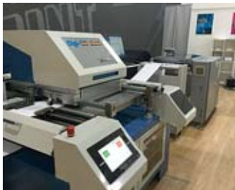
Digi-M-Jet von Digikett ist ein kompakter Vollfarbendruckturm.
