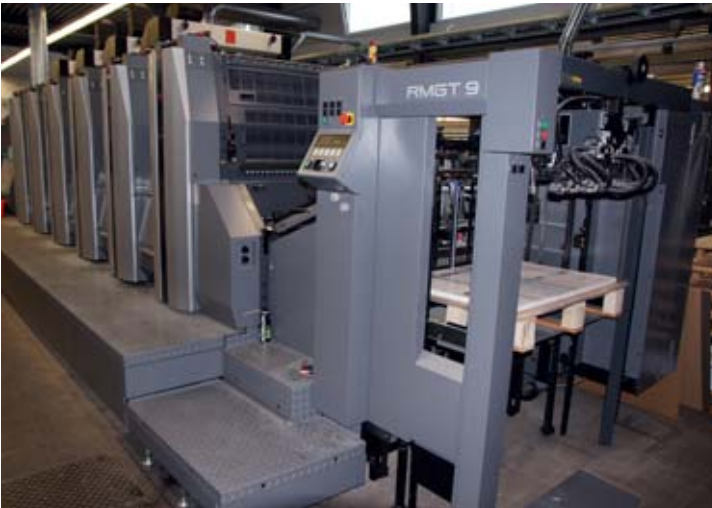
Großinvestition bei Heimert Print am Standort Einbeck in 2017: die Offsetdruckmaschine RMGT 925 mit Lackwerk. Ihr effizienter Format-Einsatz ermöglicht 16-Seiten-Produktionen mit hohem Einsparpotenzial gegenüber dem 3b-Format. Der Vertrieb erfolgte über Konica Minolta Industrial Printing.
