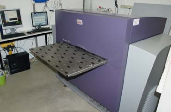
Der Kodak Magnus 400 – von der Firma Wesseler mit Garantie installiert – ist der erste CtP-Belichter bei Gräuler und passt ins Produktionsspektrum.
