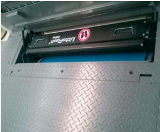
Bei den RMGT-Maschinen befindet sich LithoFlash Inline unter der Galerie.
