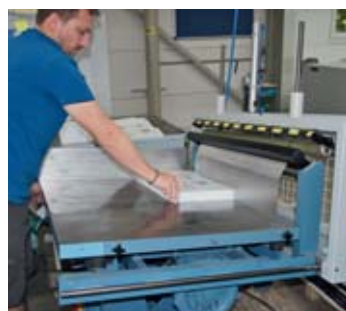
Der Schüttelautomat mit Ausstreichwalze erlaubt korrektes Arbeiten vor dem Schneidprozess.
