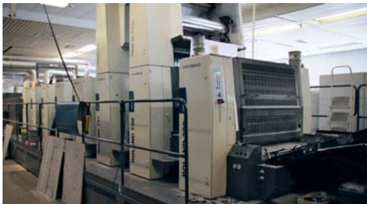
Die manroland 700 ist die einzige Offset-Maschine der Druckerei. Hier werden vor allem Aufträge mit aufwändigen Veredelungen produziert.
