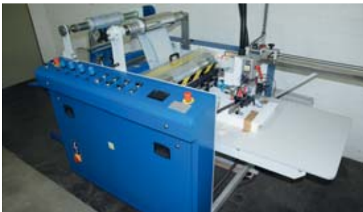
Das Kaschiersystem Europa von AVD bei Erdtmann ist mit dem optionalen Rewinder ausgerüstet, um optische Effekte durch partielle Veredelung tonerbasierter Digitaldruckfarben mit Veredelungsfolie (Sleeking) zu erzielen.
