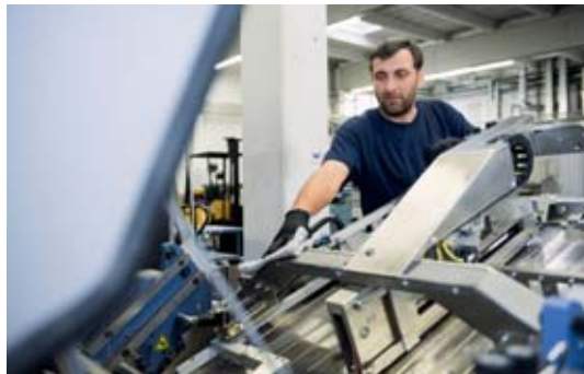
Maschinenüberholung am Beispiel einer Falzmaschine MBO K800 6 SKTL – der Reinigungsprozess.
