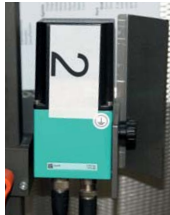
Der Bildabgleich über Kameras erzeugt bei Nichtübereinstimmung einen Maschinenstopp.
