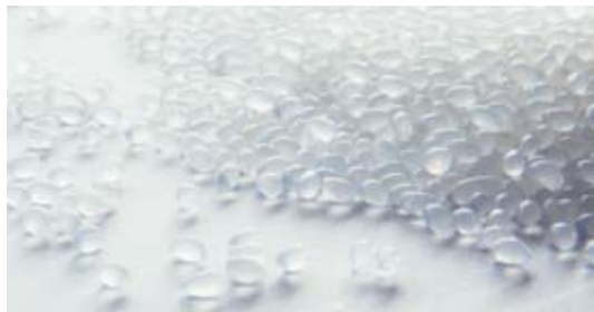
Das Granulat des Planamelt-Klebstoffes wird kurz vor dem Klebebinde-Vorgang aufgeschmolzen.
