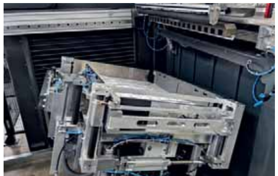
Die BASA evolution übergibt die geschüttelten, ausgerichteten und ausgepressten Lagen direkt auf den Hintertisch der Schneidemaschine, an einen Pufferspeicher – oder wahlweise auch gleich an zwei Schneidemaschinen.
