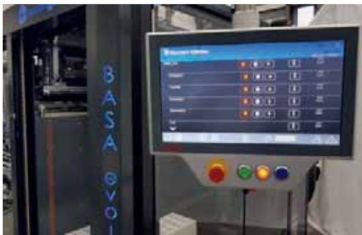
Die BASA evolution übergibt die geschüttelten, ausgerichteten und ausgepressten Lagen direkt auf den Hintertisch der Schneidemaschine, an einen Pufferspeicher – oder wahlweise auch gleich an zwei Schneidemaschinen.
