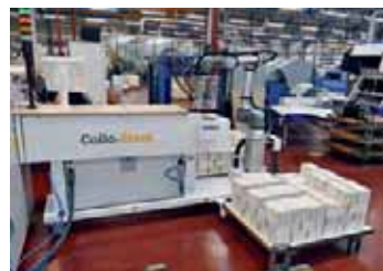
Der MBO-Palettenanleger mit Einstapel-Absenk-System (l.), die palamides-Auslage und der MBO CoBo-Stack-Roboter (r.) bilden die perfekte Peripherie, um die volle Leistung der MBO T1120 mit geringstem Personaleinsatz zu erreichen.
