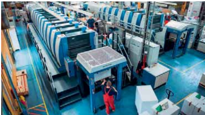
Zweimal Rapida 106 bei Kroha: die neue Maschine im Vordergrund bietet durch Doppellack-Ausstattung ein deutliches Leistungsplus.
