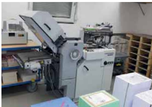
Schnelle Auftragswechsel durch geringe Rüstzeiten bietet der Heidelberg Stahlfolder Ti 40 aus dem Jahr 2009.
