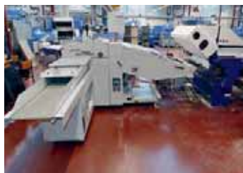
Der MBO-Palettenanleger mit Einstapel-Absenk-System (l.), die palamides-Auslage und der MBO CoBo-Stack-Roboter (r.) bilden die perfekte Peripherie, um die volle Leistung der MBO T1120 mit geringstem Personaleinsatz zu erreichen.
