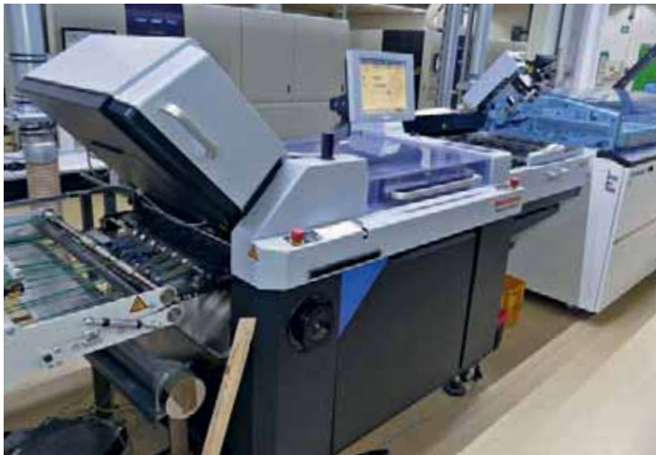
Die neue Horizon-Falzmaschine AFV-566F wurde zusammen mit dem Horizon Digital Interface in eine Rollen-Weiterverarbeitungslinie integriert.
