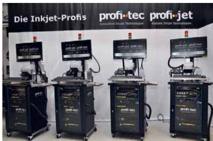
Die von profi-tec entwickelten, mobilen One-for-all-Druckcontroller lassen sich mühelos an den jeweiligen Maschinenstandort mitnehmen und bei Bedarf an verschiedene Aggregate anschließen.
