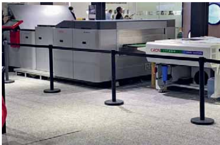
Auf einer Länge von nur 6,07m vereint Cron den Platten-Autoloader, den Belichter mit Double Drum und integrierter Stanzung sowie die Online-Entwicklungsmaschine (ohne Plattenstapler).
