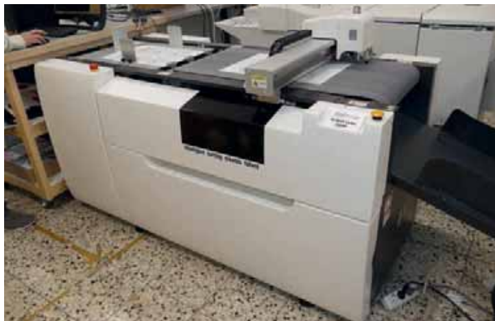
Die Digitalstanze M iCut Echo 6040 von Mehring erledigt bei Tri-Punkt jetzt individuelle Stanzungen, Rillungen, Perforationen und Anschnitte.
