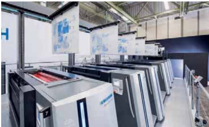
Mit Plate to Unit, der neuen vollautomatischen Druckplattenlogistik an der Druckmaschine, erfolgt die Bereitstellung der Druckplatten und deren Entsorgung komplett automatisiert.
