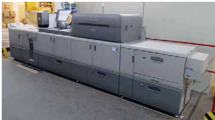
Die von Nothnagel installierte Ricoh Pro C9200 produziert bei BauerPrint mit 115 Seiten pro Minute eine mit dem Offset vergleichbare Druckqualität.
