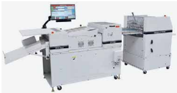
Die Therm-O-Type-Kaschiermaschine Glue-Tech SA-2130 von binderhaus kaschiert Papier oder Pappe bis zwei Millimeter Gesamtstärke im B2-Format.
