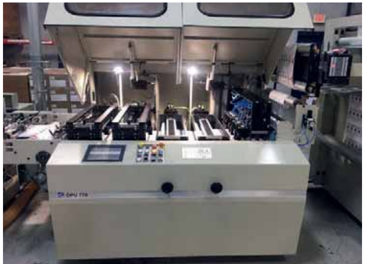
Das DPU 600-Modul ist ein voll variables, dynamisches Querperforations- und Rillmodul inklusive sechs programmierbarer Längsperforationen.
