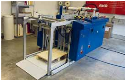
Bei AVD Deutschland derzeit stark im Fokus: die Abstapler für Kaschiermaschinen, die in den Größen 540 x 740 mm bis 1.050 x 1.050 mm produziert werden.
