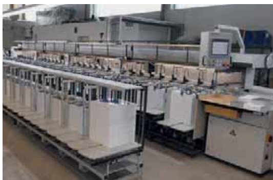
Als Hybrid-Maschine wird die tb flex B 216 SP aus 2017 für das Zusammentragen im Format 25 x 70 cm mit 32 Stationen oder für die Kalenderfertigung mit Womako-Automaten im Format 50 x 70 cm mit 16 Stationen eingesetzt.
