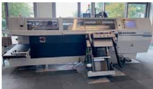
Der Quickbinder Edition Digital ist zur wirtschaftlichen Verarbeitung von Kleinstauflagen konzipiert und verfügt über einen sehr hohen Automatisierungsgrad.
