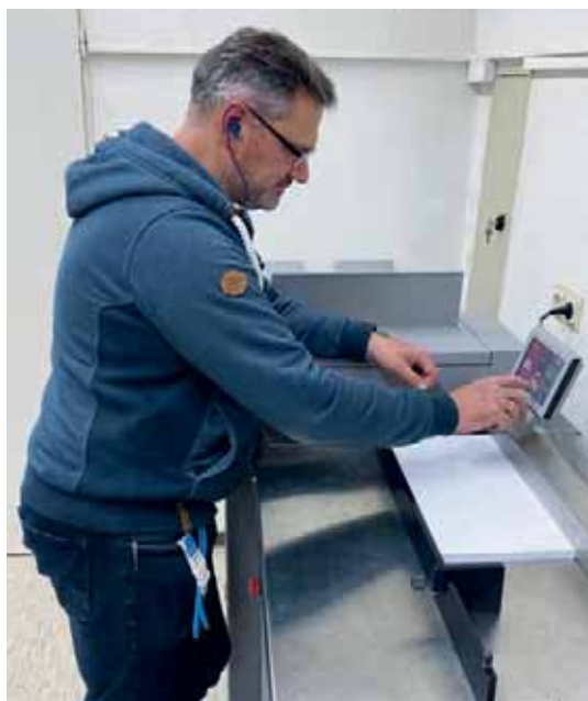
Sachbereichsleiter Andreas Ullrich: »Bei Standardfaltungen wird nur die Papierlänge und Falzart eingegeben – den Rest erledigt die Maschine automatisch.«
