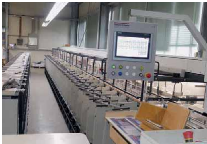
Die vierte Zusammentragmaschine von Theisen & Bonitz im Hause Laumer ist eine tb flex B 332 SP mit 32 Stationen und einer Vorstapel-Einrichtung.
