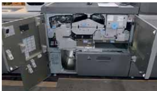
Die Ricoh Pro C9200 ermöglicht eine unterbrechungsfreie Produktion durch den Austausch von Toner und Papier im laufenden Betrieb – ideal für hohe Auflagen.
