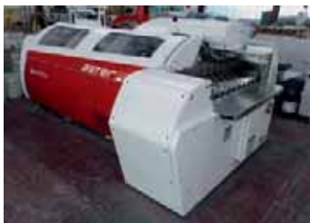
Idupa-Spezialität: Die Aster-Pro-Fadenheftmaschine ermöglicht offene Fadenheftungen mit super Layflat-Eigenschaften und auch farbigen Fäden.
