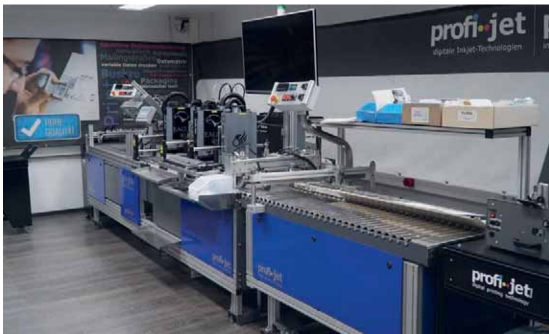
Blick in den Showroom bei profi-tec in Rheine. Hier können sich Interessenten von der Flexibilität und Leistungsfähigkeit der Drucksysteme überzeugen. Die gezeigte Maschine kombiniert verschiedene MCS-Druckmodule und Tinten. Sie ermöglicht damit eine hybride Produktion von wasserbasierenden und UV-trocknenden Anwendungen.
