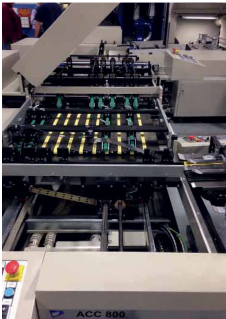
Das patentierte ACC 800-Design ermöglicht eine hohe Beschleunigung des rechten Winkels zwischen zwei rechtwinkligen Falzabschnitten und kann auch als Zubehör für jede Finishinglinie eingesetzt werden.
