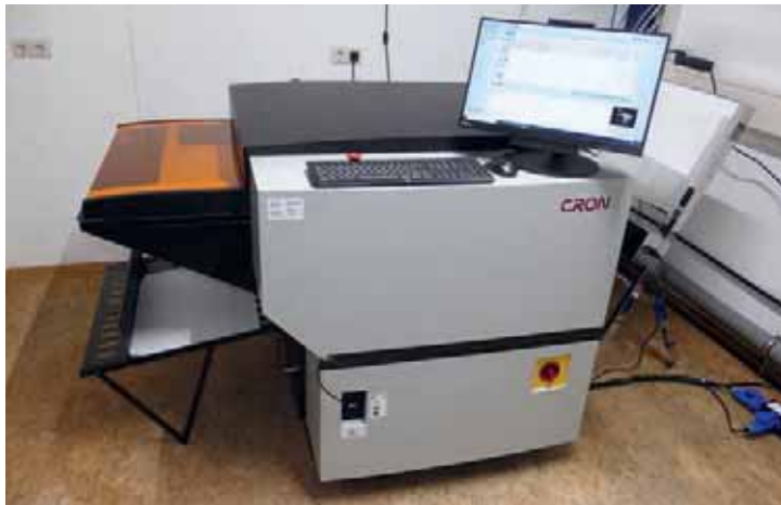
Cron-Belichter sind die Lieblingsobjekte von Pixarus, hier der CtP-Belichter Cron TP 2624 H mit vollautomatischer Plattenzuführung und Stanze.
