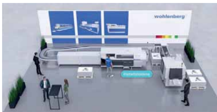
Der Quickbinder Edition Digital und der Dreischneider D09 – System DGR bilden virtuell eine automatisierte Klebebindelinie von Wohlenberg.
