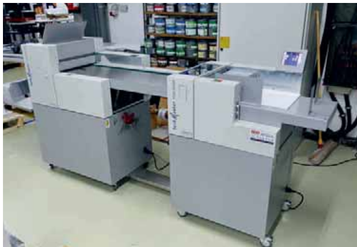
Das FKS/Multigraf-Modell Touchline TCF 375 an der Touchline CP 375 Duo rillt, perforiert und falzt in einem Arbeitsgang. Seit November 2020 kann Walter Perspektiven die vielfältigsten Einsatzmöglichkeiten hierzu nutzen.
