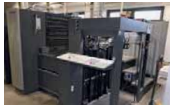
Der Preset-Plus-Anleger sorgt für eine präzise Ausrichtung des Bogens mittels zentralem Saugband und pneumatischer Ziehmarke als Start in eine optimale Produktion.
