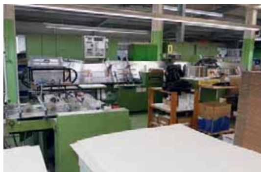
Als Hybrid-Maschine wird die tb flex B 216 SP aus 2017 für das Zusammentragen im Format 25 x 70 cm mit 32 Stationen oder für die Kalenderfertigung mit Womako-Automaten im Format 50 x 70 cm mit 16 Stationen eingesetzt.
