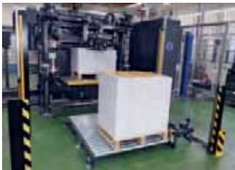
Palettenstapel mit Papieren ab 60 g/m 2 werden im Automatikbetrieb der BASA ohne Bediener-Eingriff zu geschüttelten, ausgerichteten Lagen in der gewünschten Höhe für den weiteren Verarbeitungs-Prozess hergerichtet.
