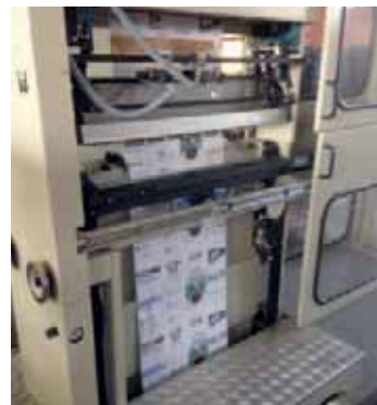
Der TUU 770 ist ein Nonstop-Null-Register-Abroller mit doppelseitig aufgebrachtem Klebeband zur Stoßanklebung. Es gibt ihn mit zwei verschiedenen Rollenpuffer-Größen. Rechts ein Bild des geöffneten Splice- und Anklebomoduls.
