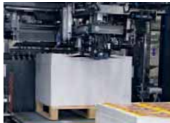
Palettenstapel mit Papieren ab 60 g/m 2 werden im Automatikbetrieb der BASA ohne Bediener-Eingriff zu geschüttelten, ausgerichteten Lagen in der gewünschten Höhe für den weiteren Verarbeitungs-Prozess hergerichtet.
