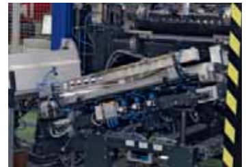
Palettenstapel mit Papieren ab 60 g/m 2 werden im Automatikbetrieb der BASA ohne Bediener-Eingriff zu geschüttelten, ausgerichteten Lagen in der gewünschten Höhe für den weiteren Verarbeitungs-Prozess hergerichtet.
