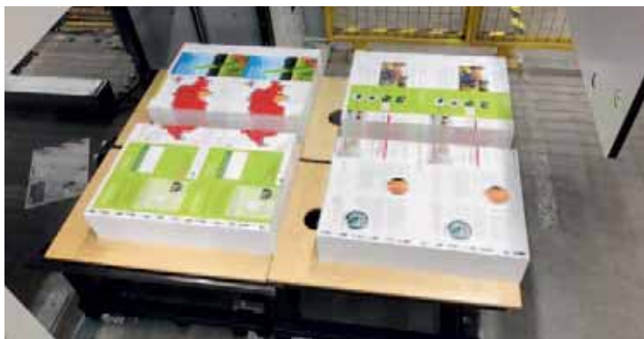
Vier Wagen des Theisen & Bonitz-Vorstapelsystems können magnetisch miteinander fixiert werden und anstatt einer Palette in den Ablader eines Schneidsystems – z.B. Transomat von Polar – gefahren werden. Anschließend dienen sie dem gemeinsamen Transport zur Zusammentragmaschine.
