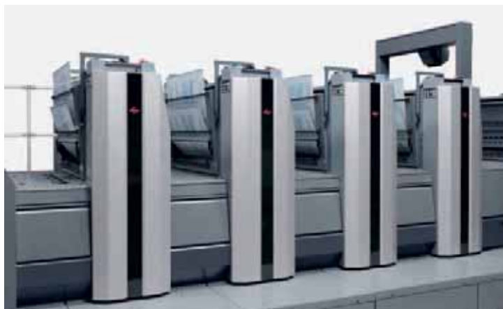
Im Vergleich zu Druckmaschinen im B1-Format weist die RMGT 970 deutlich niedrigere Plattenkosten (minus 20 Prozent) auf.
