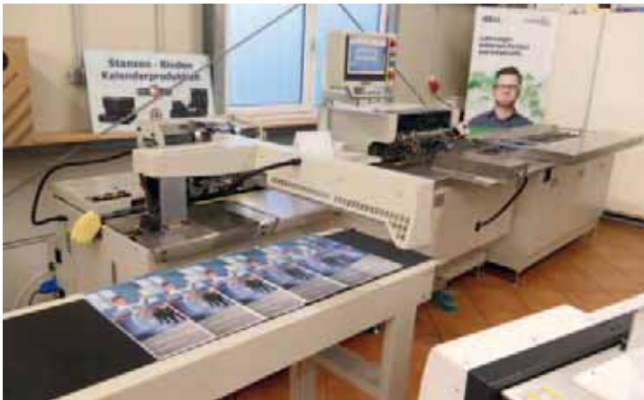
Der Vollautomat Magnopro Bind 580 S für Drahtbindungen leistet bis zu 1.500 Takte/Std. – vom Aufstellkalender bis zum 58 cm breiten Wandkalender.
