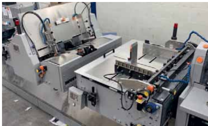
Der gerade von Hohner neu eingeführte, frei positionierbare Planobogen-Anleger PAL ergänzt Umschlag- und Bogenanleger in idealer Weise.
