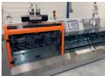
Auch die vier solo angetriebenen vertikalen Bogenanleger sowie die Drahtheftstation haben sich dank Software-Updates weiterentwickelt.
