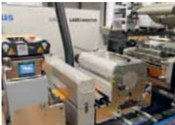
Für die Produktion von der Rolle stehen drei Generationen an Gallus-Maschinen zur Verfügung: die neue Gallus Labelmaster (l.), die Gallus R 160 und die Gallus T 330 S. Buch-, Flexo- und Siebdruckanwendungen sind damit möglich.
