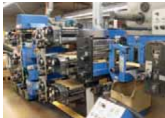
Für die Produktion von der Rolle stehen drei Generationen an Gallus-Maschinen zur Verfügung: die neue Gallus Labelmaster (l.), die Gallus R 160 und die Gallus T 330 S. Buch-, Flexo- und Siebdruckanwendungen sind damit möglich.
