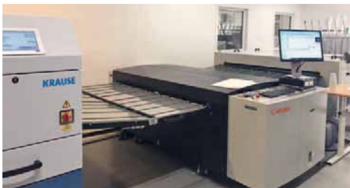
Herzstück der VLF-Plattenproduktion ist der Cron-Außentrommelbelichter für maximal 1.860 mm Plattenbreite mit integrierter Registerstanzung.
