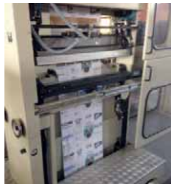
Der TUU 770 ist ein Nonstop-Null-Register-Abroller mit doppelseitig aufgebrachtem Klebeband zur Stoßanklebung. Es gibt ihn mit zwei verschiedenen Rollenpuffer-Größen. Rechts ein Bild des geöffneten Splice- und Anklebomoduls.
