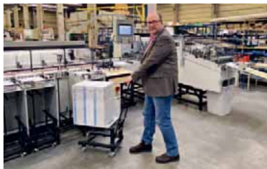
Achim Theisen demonstriert die einfache Handhabung des mobilen Vorstapelsystems von Theisen & Bonitz. Er zeigt auch, wie aus der kontinuierlichen Stapelauslage (r.) die gezählten Stapel bequem abgenommen werden können.
