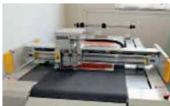
Seit Januar 2021 sorgt ein dms digital Sinajet DF 0906-MT-Flachbettplotter bei Wagner für die präzise Fertigung von Schachteln, Mappen und Etiketten.
