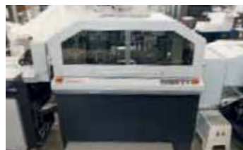
Der Horizon StitchLiner Mark III mit vier Türmen sorgt bei kraus print u. media für eine noch effizientere Produktion rückstichgehefteter Broschüren.
