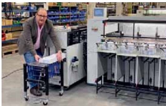
Achim Theisen demonstriert die einfache Handhabung des mobilen Vorstapelsystems von Theisen & Bonitz. Er zeigt auch, wie aus der kontinuierlichen Stapelauslage (r.) die gezählten Stapel bequem abgenommen werden können.
