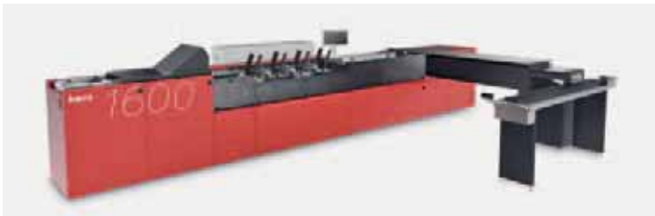
Die Geschwindigkeit des Kompakt-Multiformat-Systems Kern 1600 (bis zu 12.000 Takte/h) wird derzeit von den Kern-Ingenieuren weiter erhöht.
