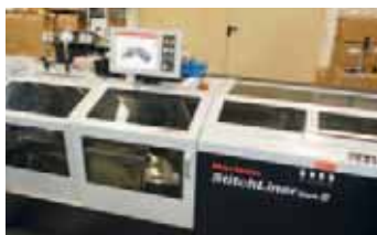
Der Horizon StitchLiner Mark III mit vier Türmen sorgt bei kraus print u. media für eine noch effizientere Produktion rückstichgehefteter Broschüren.
