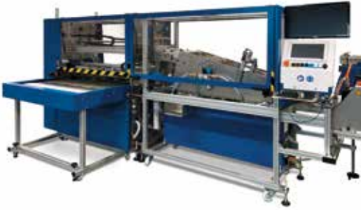
Der SmartPack100 befüllt automatisch Trays mit gefalzten Outserts.
