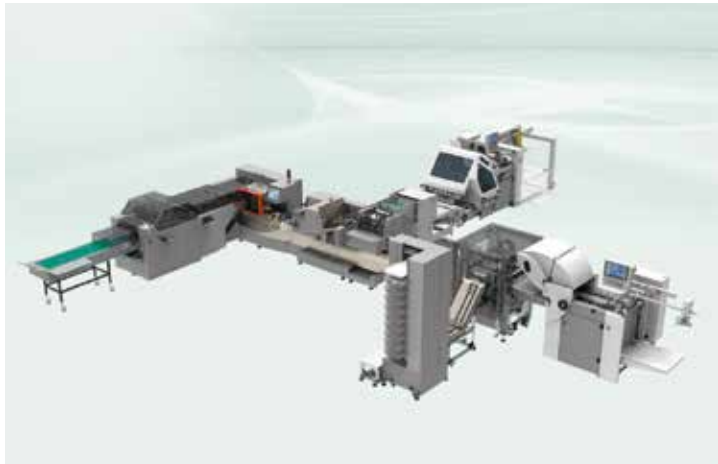
Eine der möglichen Ausbaustufen der HHS-Futura ist diese Konfiguration mit Sammelhefter, Kreuzbruch- und Taschenfalzaggregaten (hier von Postpress-Alliance-Partner MBO) sowie einer Turmzuführung aus dem Hause Hohner.
