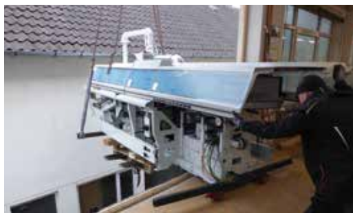
Die Einbringung des Klebebinders City e in den ersten Stock durch ein ausgebautes Fenster war Millimeterarbeit.
