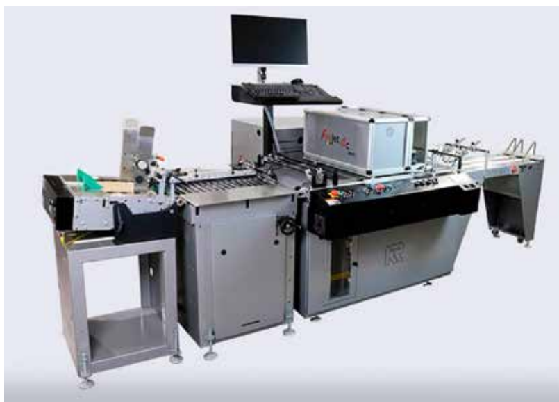
Der FireJet 4c von Kirk-Rudy auf einer Basisstation mit vorgeschaltetem Feeder, Ausrichtstrecke und Förderband.
