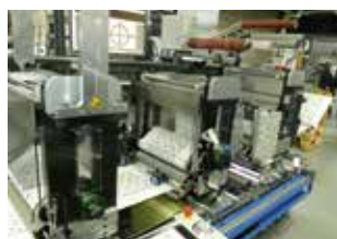
Die Gallus-Maschine ist mit drei Stanzeinheiten ausgestattet.
