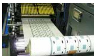
Von Rolle-zu-Rolle – bei Flach ist mit Querschneider und Bogenstapler aber auch Rolle-zu-Rolle möglich.
