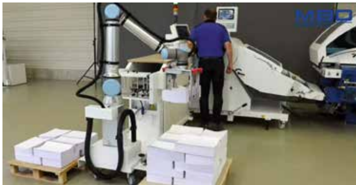
Live-Demo des CoBo-Stack an einer MBO K8RS: Der frei arbeitende Roboter übernimmt das Abstapeln, entlastet den Bediener und ermöglicht signifikante Leistungssteigerungen. Das Absetzschemata wird automatisch berechnet.
