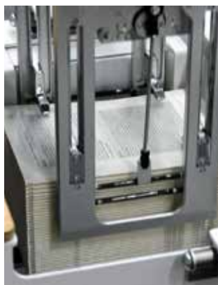
Der Greifer des CoBo-Stack nimmt Formate von 95 x 210 bis 260 x 340 mm auf. Die Maschine bewältigt bis zu 300 Takte pro Minute und hebt Stapel mit einem Gewicht von bis zu sechs Kilogramm.
