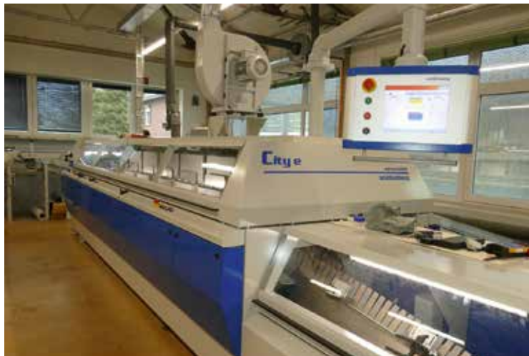
Der Wohlenberg-Klebebinder City e ist seit April 2021 beim Merkur Verlag Rinteln mit bis zu 6.000 Takten pro Stunde im Einsatz.
