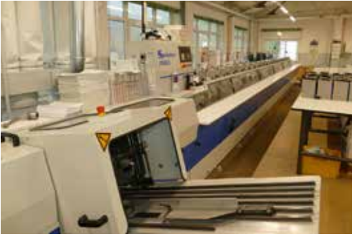
Die Wohlenberg-Zusammentragmaschine Sprinter mit 20 Stationen, Falschbogenkontrolle, Handzulegenstation und Criss-Cross-Auslage wurde beibehalten.
