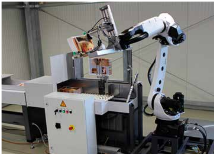
Der P-Stacker basiert auf einem ausgereiften Industrieroboter mit Spezialgreifer. Er übernimmt das kräftezehrende Absetzen auf die Palette.
