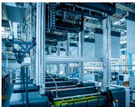
Für den automatisierten, simultan an allen Druckwerken ablaufenden Plattenwechsel hängt ein kompletter Plattensatz in Bereitschaft.
