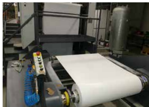
Mit dem Mabeg-Rollenschneider RS 104, einem Rolle-zu-Bogen-Anleger lassen sich kostengünstige Rollenmaterialien auf der Roland Evolution R707 LTTLV bedrucken.
