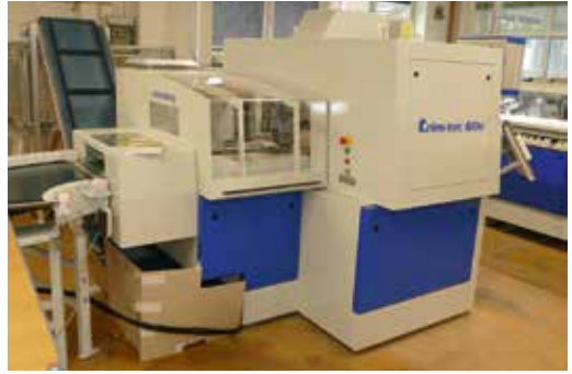
Der neue Inline-Dreischneider Wohlenberg trim-tec 60e mit integriertem Vorstapelmagazin und einem hohen Automatisierungsgrad.
