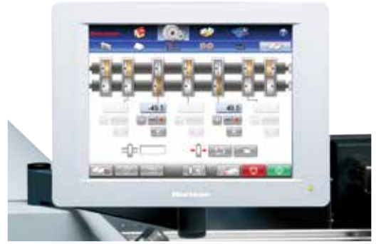
Rillwerkzeug-Positionierung mit dem Score Navigator.
