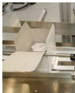
Die Kartonaufstellung, Zuführung zum automatischen Einschweißen, Beipackzettel-Zuführung und Kartonverpackung.
