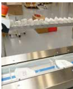
Die Kartonaufstellung, Zuführung zum automatischen Einschweißen, Beipackzettel-Zuführung und Kartonverpackung.
