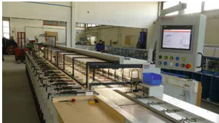
Die neue Zusammentragmaschine tb flex S 316 SP von Theisen&Bonitz sorgt bei Albrecht für zweischichtiges, schnelles und sicheres Abarbeiten von Aufträgen.
