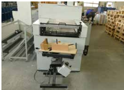
Im Rechtslauf wird die kontinuierliche Auslage genutzt, wo Sätze gezählt und zu Stapeln bis zu 15 cm Höhe gesammelt werden. Im Linkslauf wird der Schüttler für Blattsammlungen genutzt und sorgt für einen exakten Anschlag der Blätter.
