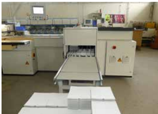
Im Rechtslauf wird die kontinuierliche Auslage genutzt, wo Sätze gezählt und zu Stapeln bis zu 15 cm Höhe gesammelt werden. Im Linkslauf wird der Schüttler für Blattsammlungen genutzt und sorgt für einen exakten Anschlag der Blätter.
