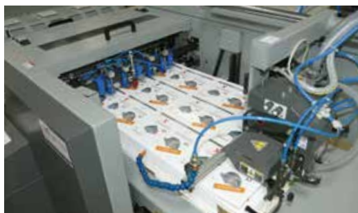
Eine automatische Blattszufuhr mit dem Komfi-Design-Zuführungkopf sorgt für einen reibungslosen Papiertransport.
