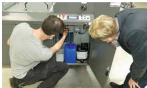
Ein einfach zu bedienendes Lack-Nachfüllsystem macht die Fullmatic 52 noch anwendungsfreundlicher.
