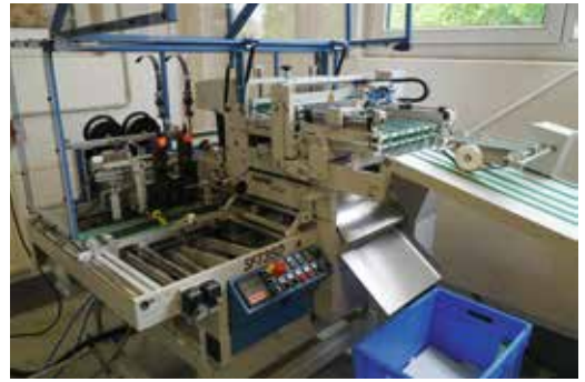
Das separate Heft- und Falzaggregat mit Frontbeschnitt wurde auf Kundenwunsch für die Aufnahme zweier Hohner-Heftköpfe umgebaut.
