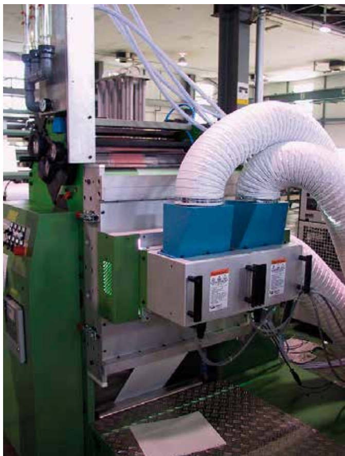
Das UV-Lackierwerk VAU 600 von GEP (Global Ehret Processing Technology) mit Inertisierungskammer zur Trocknung spezieller UV-Silikonlacke im Einsatz.
