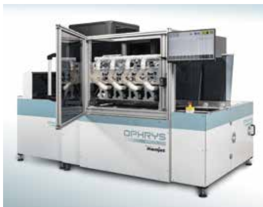
Effizienzsteigerung im Kuvertierprozess – der neue Ophrys Iricolor bedruckt Umschläge inline direkt nach dem Kuvertieren.
