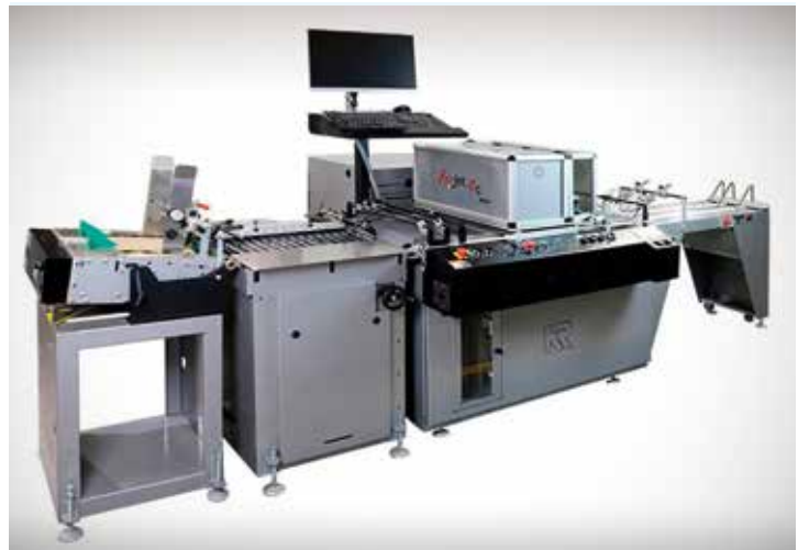
Der FireJet 4C kann problemlos in einen Kuvertierprozess integriert werden.
