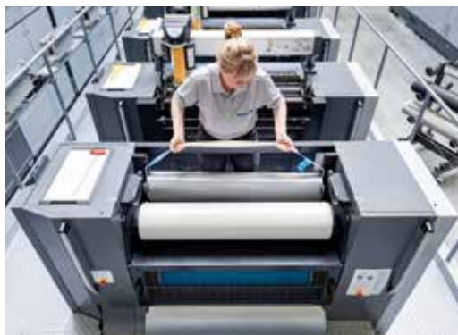
Ein Highlight ist das neue Lackierwerk für effiziente und flexible Veredelung in Top-Qualität, konzipiert auf Basis der XL-Technologie von Heidelberg.
