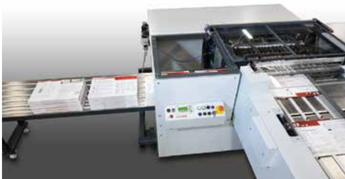
Im Linkslauf arbeitet die tb flex B 320 SP in eine kontinuierliche Stapelauslage. Hier werden die Blätter zu geraden oder versetzt ausgelegten Stapeln bis zu 15 cm für das Weiterverarbeiten in Fremdmaschinen gesammelt.
