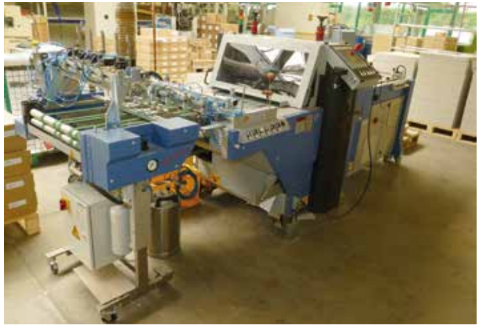
Die Kompatibilität mit Querschneidern, Digitaldruckmaschinen, Falzmaschinen, Auslagen und Mailinganlagen macht die Rotationsstanze BSR-550 von Bograma (auch ohne Anleger) für die Mailing Papierverarbeitung vielseitig einsetzbar.
