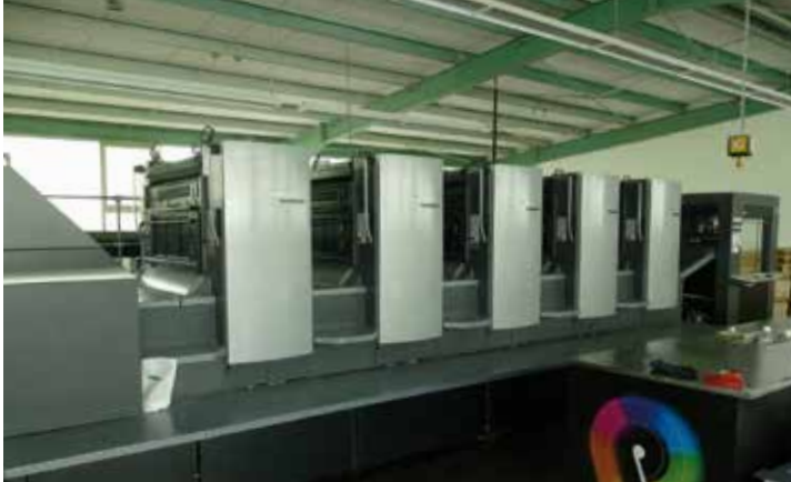
Seit März 2017 produziert Petermann mit einer Heidelberg Speedmaster CS 92-5. Die Maschine mit dem Format 65 x 92 cm hat oft eine fünfte Farbe oder Drucklack im Einsatz und dient auch Heidelberg als Vorführmodell.
