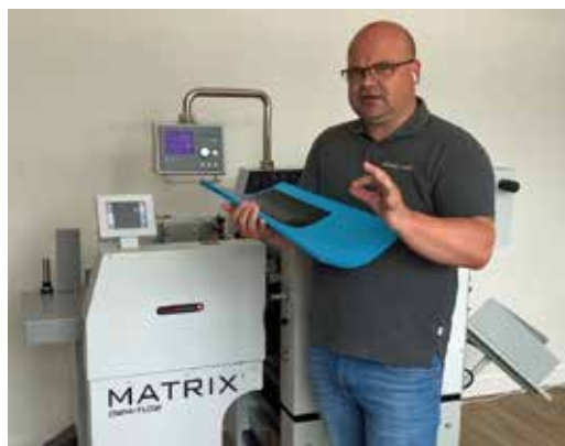
Michael Graf legt die Bögen zur Veredelung in die Matrix MX ein. Die Folie, hier mit einem Kupfer-Farbtön, haftet nur auf den schwarz bedruckten Flächen.
