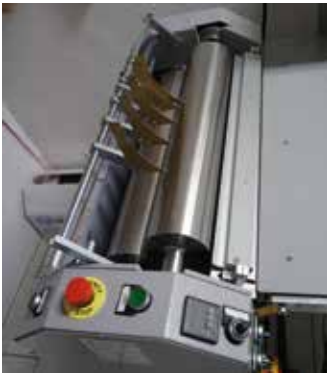
Das Leimwerk ist mit Edelstahlwalzen ausgestattet und verarbeitet Warm- und Kaltleim.
