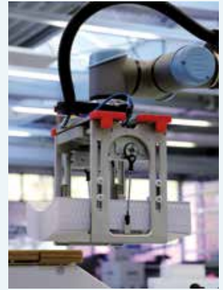
Der Greifer bewegt jetzt Produktstapel von bis zu 8 Kilogramm.
