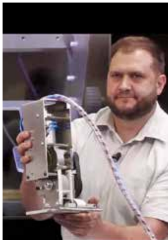
Tony Wolf von Popp präsentiert den Prototypen des innovativen Bandgreifers, der das lückenlose Palettieren ermöglicht.
