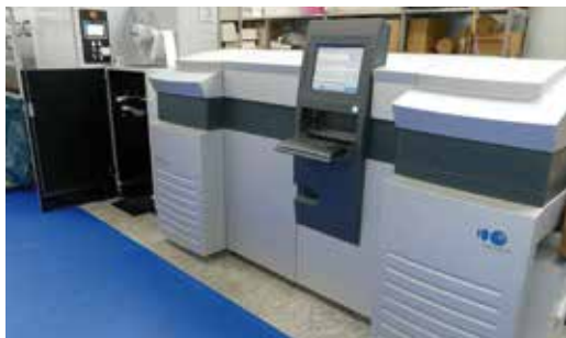
Die ursprünglichen Produkte von Imaging Solutions sind Fotobelichter, wie hier der widePrint 12nG (bis 400 m 2 /h).
