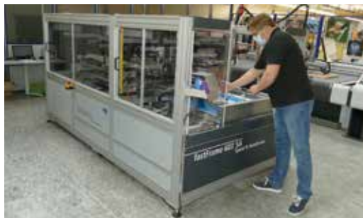
Bis zu 160 Rahmen/h in Formaten bis 610 x 610 mm lassen sich mit dem fastFrame 600 SA vollautomatisch beziehen.
