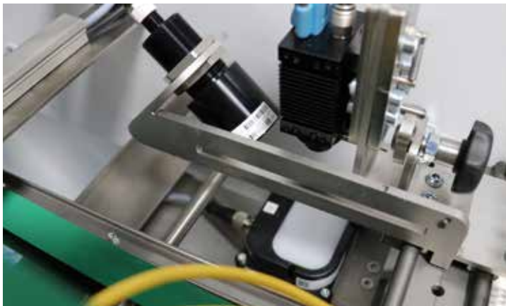
Kameras vermessen die Schneidmarkenposition relativ zur Papieraußenkante.
