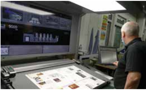
Ein 55-Zoll-Großbildschirm für den Leitstand ermöglicht die Überwachung der Druckqualität und des Betriebsstatus sowie die Echtzeitanzeige der Bogenübergabe.
