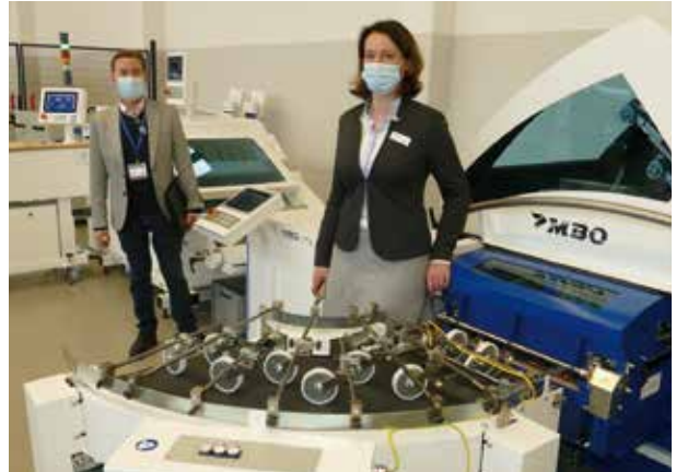
MBO-Marketingleiterin Katja Haug erklärt Matthias Siegel von der Grafische Palette die optische Falzqualitätskontrolle und den vollautomatischen Signaturenwechsel.
