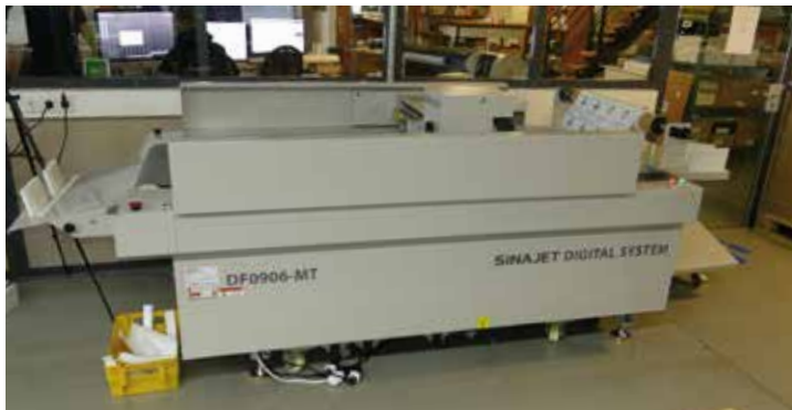
Seit Oktober 2021 bearbeitet man bei Zabel mit dem Sinajet-Flachbettplotter DF0906-MT Kleinauflagen bis zu einem Schneidformat von 600 x 900 mm.
