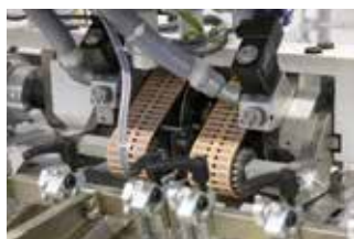
Der neue Doppel-Vacubelt verfügt über eine erhöhte Saugleistung.
