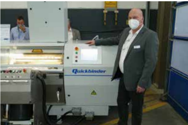
Wohlenberg-Standortleiter/COO Matthias Cordes präsentierte den Klebinder Quickbinder Edition Digital mit bis zu 2.000 Takten/h.
