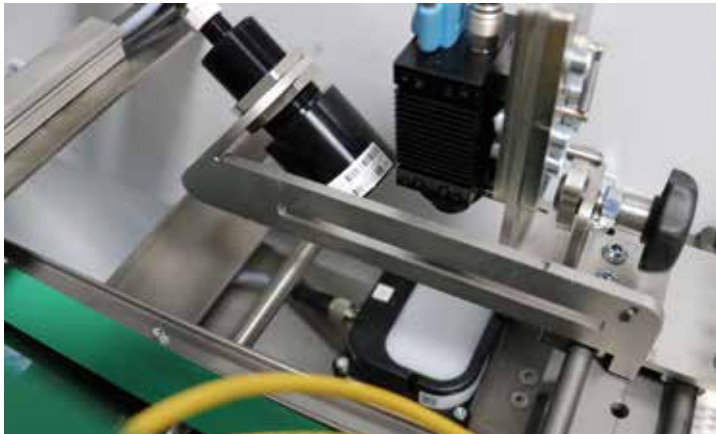
Kameras vermessen die Schneidmarkenposition relativ zur Papieraußenkante.
