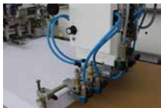
Der Trennkopf Vacujet RS erreicht bis zu 25.000 Takte pro Stunde.
