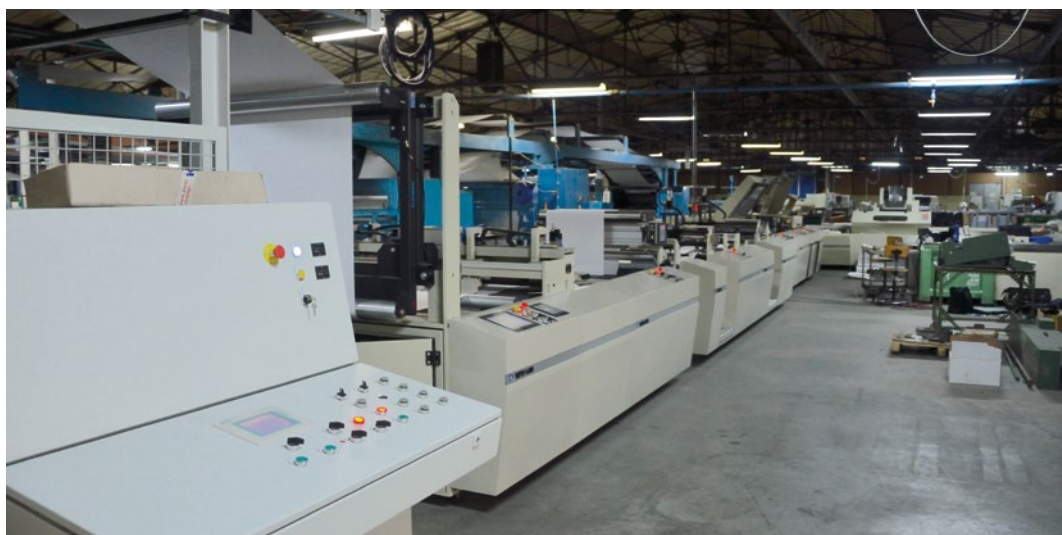
Highspeed-Schwarzweiß-Buchproduktion bei der Imprimerie Floch in Mayenne (Frankreich) mit Inline-Finishing-Anlage für klebegebundene Bücher aus dem Hause GEP Germany. Produktionsgeschwindigkeit: bis zu 320 m/min.
