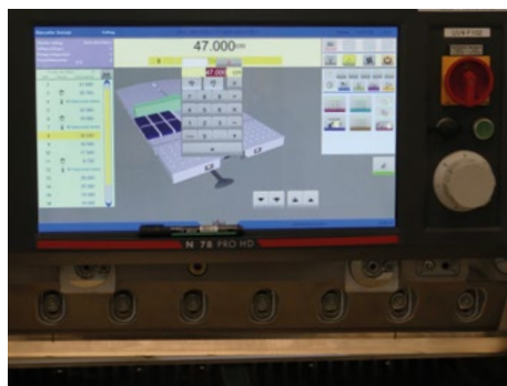
Maschinenführerin Violetta Jasinska an einem der beiden neuen, automatisierten Schnellschneider Polar N78 Pro HD. Über das große Touchscreen-Display lässt sich der Planschneider einfach und intuitiv bedienen, der Datenaustausch zwischen Vorstufe und Weiterverarbeitung erfolgt per Computcut.
