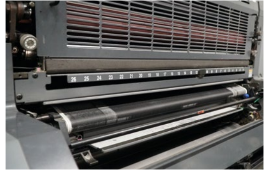
Waschwickel in Einbaulage in einem wasserlosen Druckwerk der RMGT 925. Eine Rolle reicht für 50 bis 70 Reinigungen, je nach Papiersorte.
