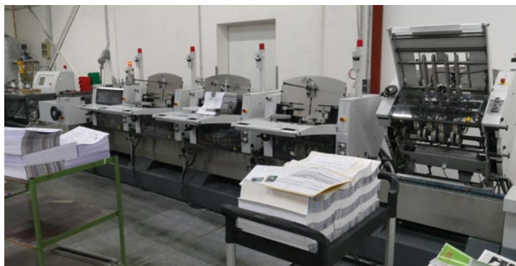
Das von Uwe Reimold eingebrachte TechniFold-Werkzeug Spine-Creaser sorgt im Sammelhefter ST 350 bei Albersdruck für optimale Umschlag-Rillungen.
