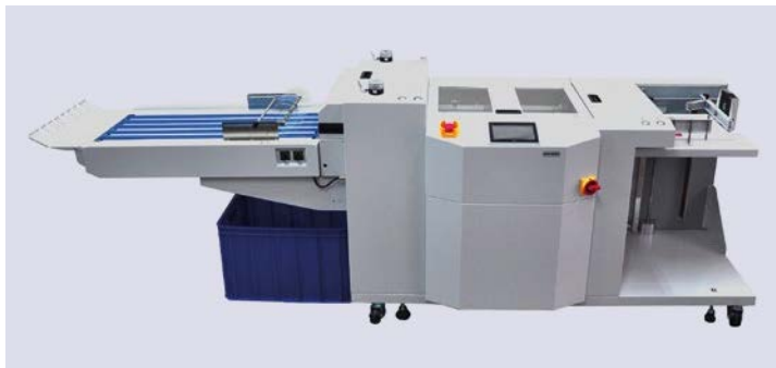
Der neue „Star“ im Maschinenpark der Druckerei Zimmer ist die Rotationsstanze Morgana RDC. Sie eignet sich vor allem für kleinere Auflagen und ist in wenigen Minuten umgerüstet.
