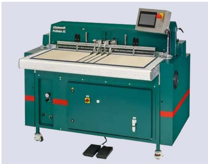
Die PräDeka XL ist eine halbautomatische Maschine zur Herstellung von Buchdecken und deckt einen großen Formatbereich von 15 x 15 cm bis 52 x 110 cm ab. Sie ist das Herzstück der Buchfertigungslösung bei Printec Solutions.
