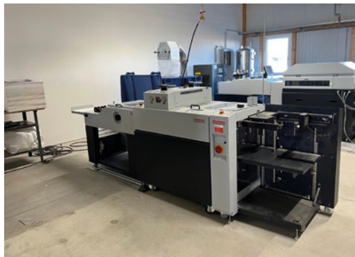
Die rotative Stanzmaschine RD-4055DM am neuen Standort in Stockstadt am Main. Sie vereint das Stanzen, Prägen, Anstanzen und Rillen in einem Arbeitsgang.
