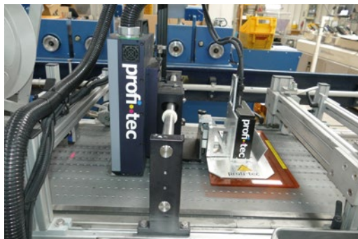
Der MCS Eagle UV überzeugt mit einer Druckbreite von 108 mm.
