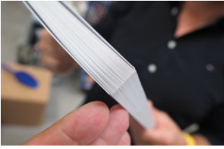
Aus der fastBook Professional: ein perfekt verklebter und abgepresster Buchblock.
