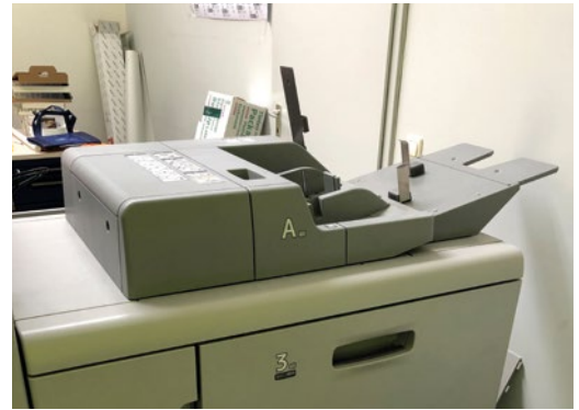
Der integrierte Finisher ermöglicht eine Sattelheftung von Broschüren mit bis zu 30 Blatt (80 g/m 2 ).
