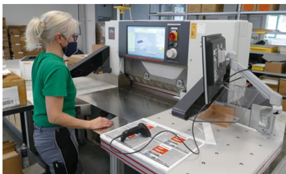
Maschinenführerin Violetta Jasinska an einem der beiden neuen, automatisierten Schnellschneider Polar N78 Pro HD. Über das große Touchscreen-Display lässt sich der Planschneider einfach und intuitiv bedienen, der Datenaustausch zwischen Vorstufe und Weiterverarbeitung erfolgt per Computcut.
