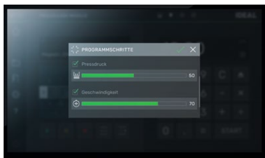
Default-Einstellungen: Bedienerspezifische Zuweisung von Pressdruck und Rückanschlag-Geschwindigkeit, automatisches Laden beim Start.
