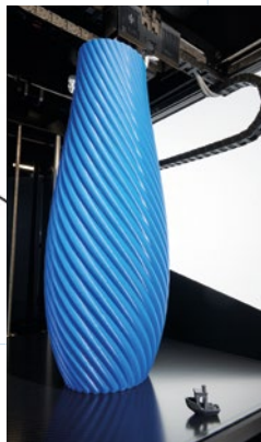
Der FDM-Drucker Eddy von Krause DiMaTec druckt mit einer Geschwindigkeit von bis zu 80 mm/sec.
