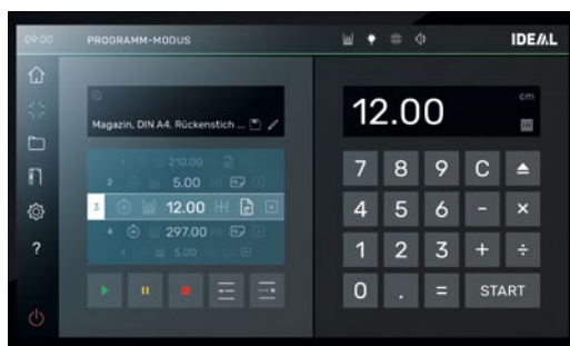
Programm-Modus: Einzelschrittanzeige mit aktiven/inaktiven Einstellungen, Schnittschritte separat editierbar, frei editierbares Textfeld für kundenspezifische Angaben.
