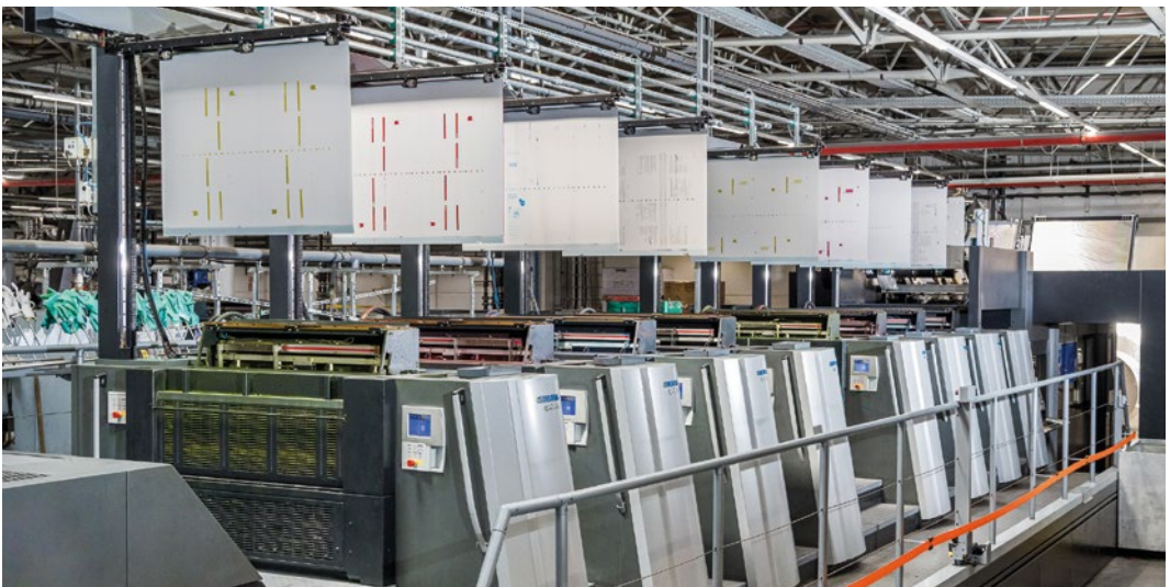
Das vollautomatische Druckplattenlogistiksystem Plate to Unit von Heidelberg schließt eine Automatisierungslücke in der Druckproduktion.
