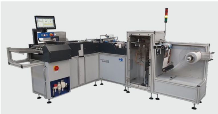
Das vollautomatische Bildschneide- und Sortiersystem für Rollen- und Bogendruckmaschinen, multiCut, der Imaging Solutions AG (Dielsdorf/Schweiz).
