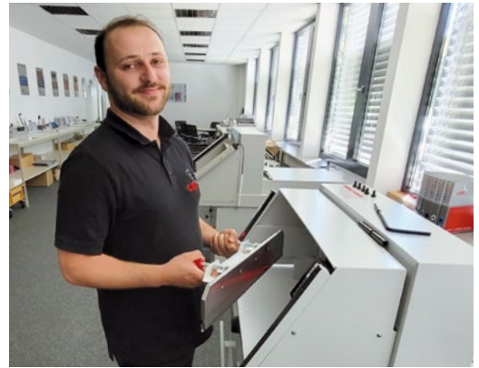
Leo's-Servicetechniker Michael Schmid beim Messerwechsel an einem elektrischen Stapelschneider Ideal 5260.
