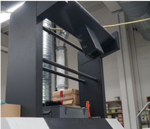
Die kamerabasierte Inline-Messung der Komori sorgt für einen stabilen Auflagedruck.
