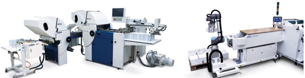
Taschenfalzmaschine MBO T50 (Bogenformat 50 x 70 cm, links) und der MBO-Abstapelroboter CoBo-Stack (rechts).
