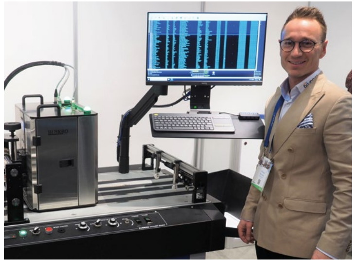
Mit dem Buskro-Inkjet-Controller, den der Geschäftsführende Gesellschafter Nicolai Brunner hier zeigt, lassen sich der Eindrucksdaten-Fluss und das Eindrucks-Layout ebenso handhaben wie die Systemdiagnose.
