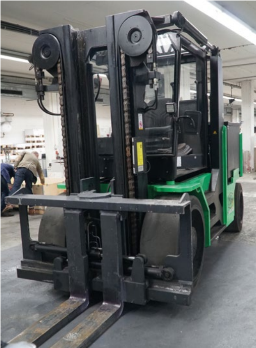
Bei den Mitarbeitern von Aribas heißt er nur „Hulk“. Der grüne Elektrostapler hebt mit seinen „Superkräften“ 14 Tonnen und kann auf engstem Raum manövrieren.
