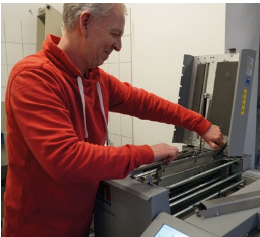
Mit wenigen Handgriffen rüstet Ulrich Vitzethum die Morgana Digifold Pro XL mit dem optionalen Kit zum Längs- und Quer-Perforieren aus.
