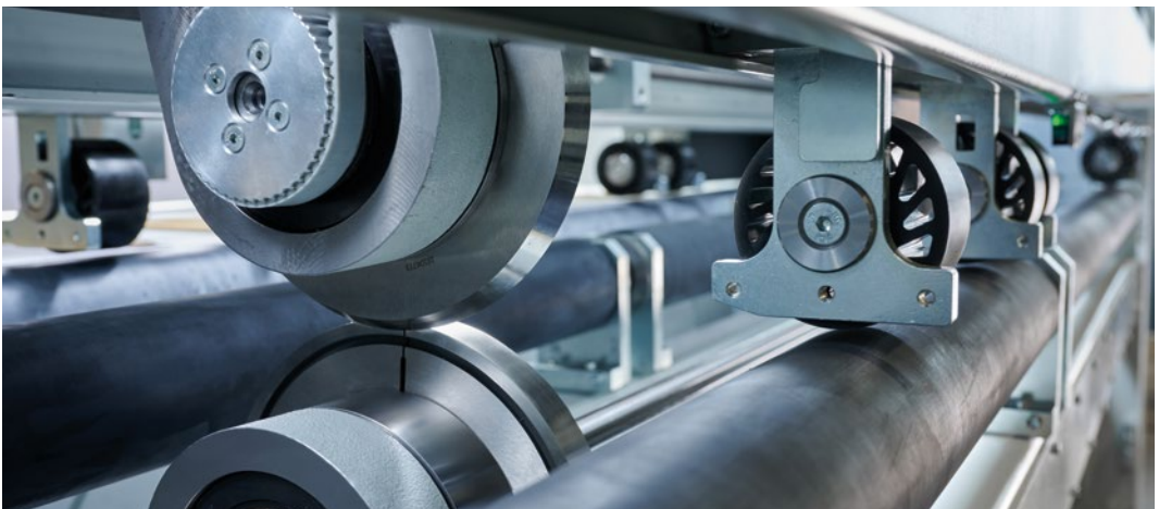
Blick in die Längsschnitt-Einheit des BX Motion Pro, hier in der Ausführung für 16 mm dicke Wellpappen. Dank der soliden Ausführung wird die Maschine mit den auftretenden Kräften problemlos fertig.
