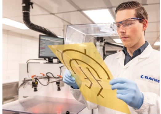
Gedruckte Heizung aus dem Drucklabor bei Elantas Europe.
