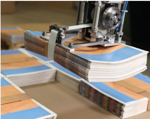
Kantgenaues Absetzen einer Bogensignatur für eine DIN-A4-Broschüre auf Palette – mit dem neuen Bandgreifer CTB.
