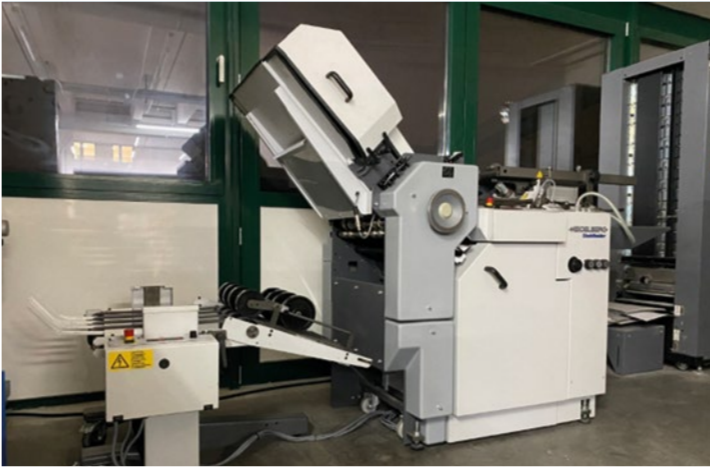
Steht da wie neu: Der aus Norwegen importierte und von Witt Falztechnik überholte Heidelberg Stahlfolder Ti 40 mit Flachstapelanleger.
