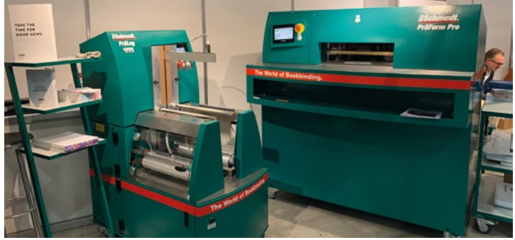
Kein manuelles Einrichten mehr dank Barcodeerkennung: Die PräLeg und die PräForm Pro gehören zum Book-1-System von Schmedt.
