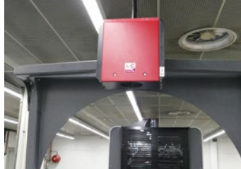
Eine einfache Nachrüstung mit Inline-Inspector für die Bogenkontrolle.
