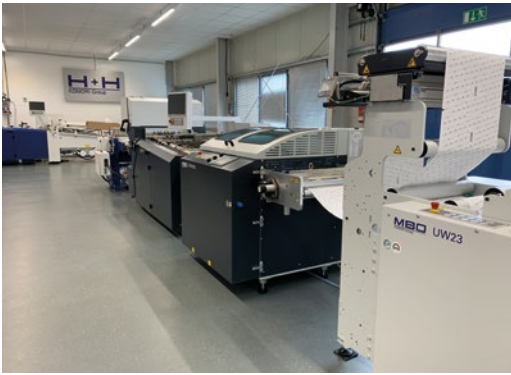
Rollenverarbeitung mit der M9 Outsert-Maschine von H+H als Kernstück der Produktionsstraße.
