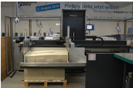
Stapeln ist ein Knochenjob, daher springt bei Piereg jetzt der Perfecta-Ablader B3auto ein.
