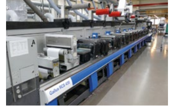
Unter sechs Gallus-Maschinen bei Reynders befindet sich auch die RCS 430, die sich durch hohe Produktivität und moderne Werke für den UV-Offsetdruck auszeichnet.
