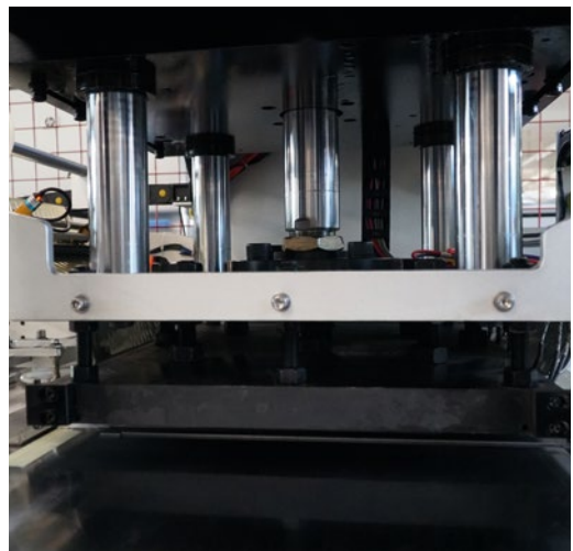
Blick in die „Herzkammer“ der PPHSB 800. Mit zehn Tonnen Druck können Bögen und Zuschnitte bis zu einer Größe von 800 x 600 mm flächig verarbeitet werden.
