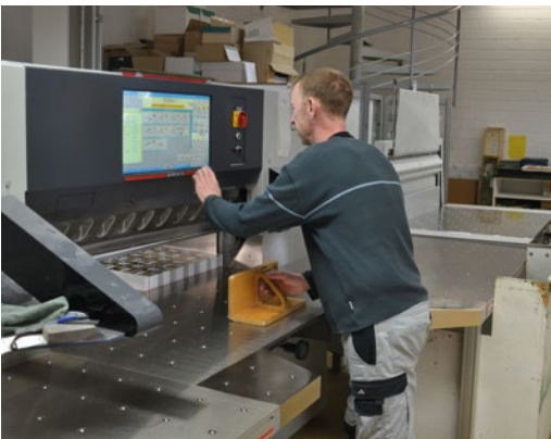
Marco Lange bedient die Polar-Schneidemaschine N115 pro HD, die unter anderem mit einem Stapellift LW 1200 ausgestattet wurde.
