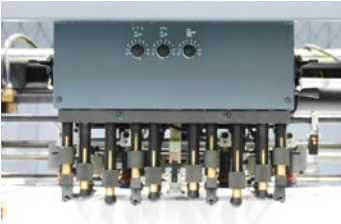
Ein Austauschsaugkopf kann die Produktions-Sicherheit enorm verbessern.
