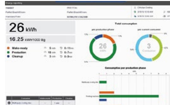
Mit dem EcologicPilot wird der Energieverbrauch der Druckmaschine und der Zusatzaggregate gemessen.
