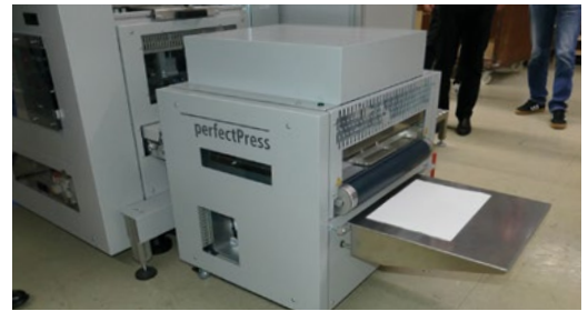
Die Inline-Buchpresse perfectPress sorgt durch gleichmäßige Anpressung für feste und kompakte Buchrücken.
