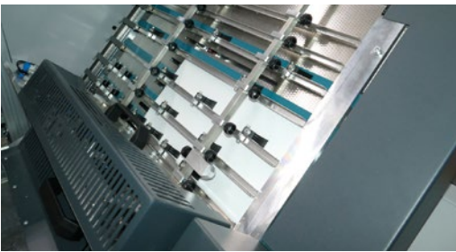
Hotmelt-Einrichtung: Sie verfügt über eine aktive Leimkopfverstellung für präzisen und homogenen Leimauftrag.
