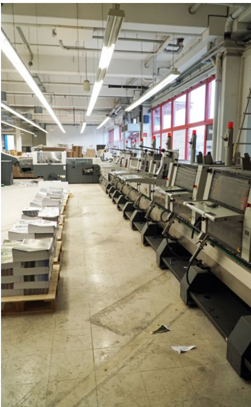
Blick auf den ST 450 in der 1.300 Quadratmeter großen Halle an der Rolshover Straße. Die Anschlusskapazität ist ausreichend für eine vollausgestattete Buchbinderei.
