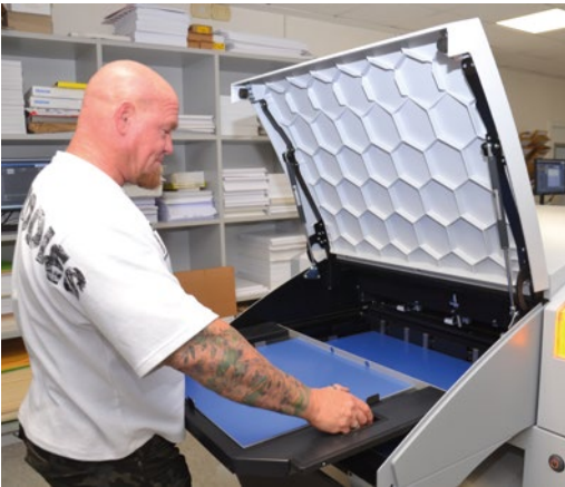
André Baumert beim einfachen Einlegen der Platten in den Heidelberg Suprasetter.
