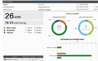
Mit dem EcologicPilot wird der Energieverbrauch der Druckmaschine und der Zusatzaggregate gemessen.
