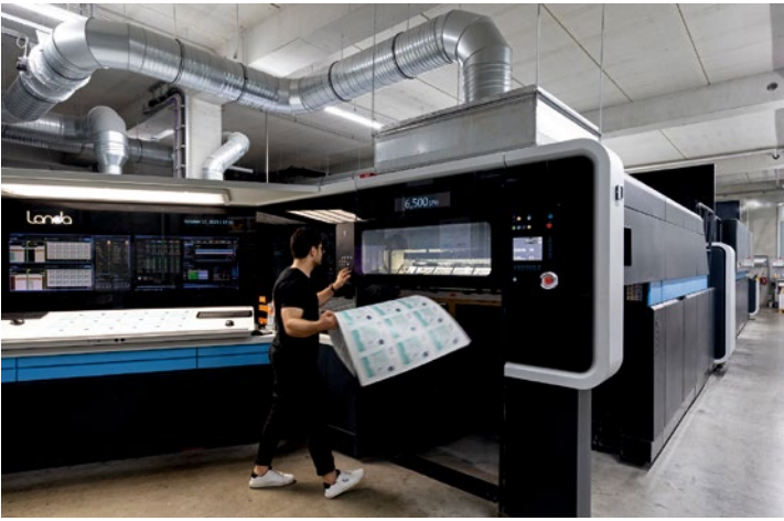
Eine konstante Luftfeuchte schützt die Landa S10P vor elektrostatischen Aufladungen und sorgt somit für beste Qualität.
