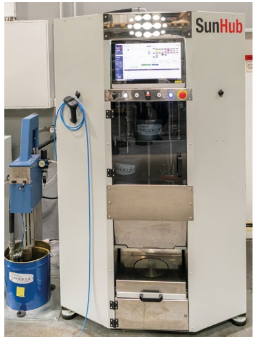
Vollautomatisches Dosieren im geschlossenen System: Der Sun Dispenser bei Steuber in Mönchengladbach.
