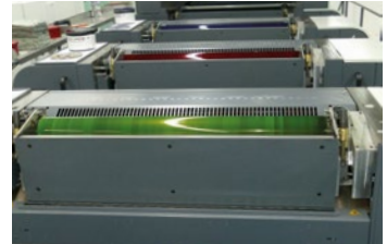
Schnellere Reinigungszeiten durch neue, anders beschichtete Farbkästen.
