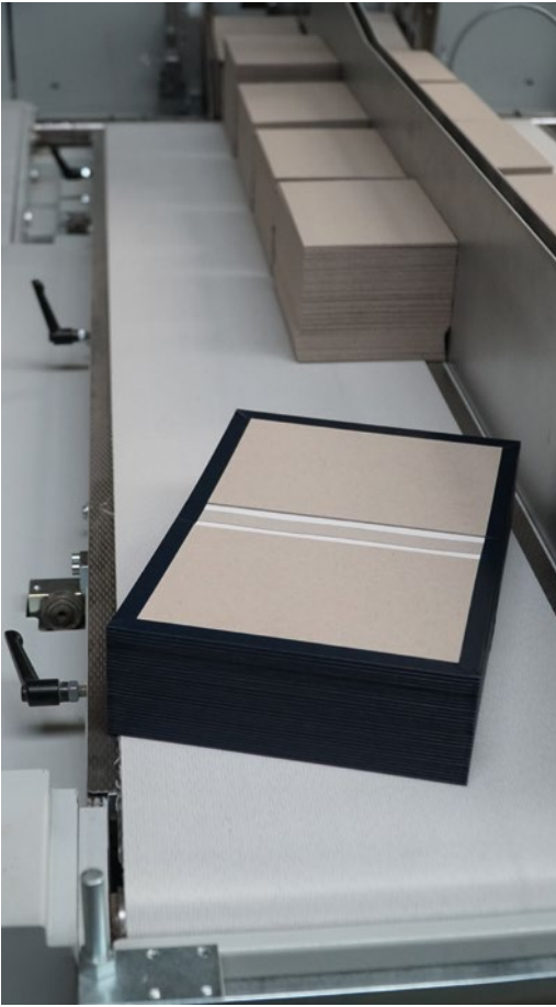
Blick auf den Pappenanleger. Die Maschine kann auch sehr dünne Pappen verarbeiten. Im Vordergrund fertige Buchdecken aus aktueller Produktion.
