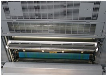
Der InlineColorPilot misst und regelt Farbe, LAB-Werte und Register.
