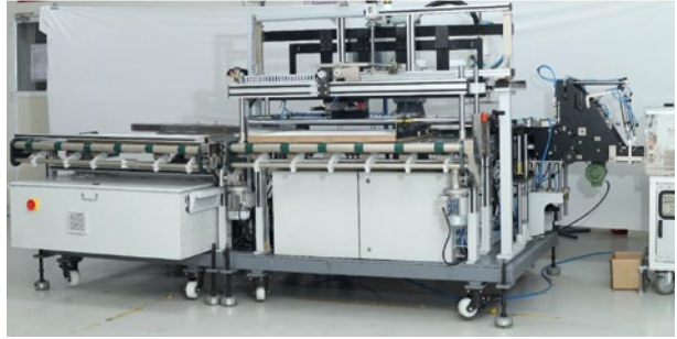
Die neue automatische Pratham-Verpackungslinie Super Tray Packer (STP 150) kann mit einer Inspektionseinheit kombiniert werden.
