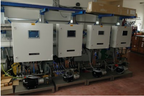
Die Aggregate für die drupa stehen zum Transport bereit. Ein letzter Blick ins Innere und Erklärungen zur Funktionsweise lassen das Prinzip erkennen, mit dem Papier-Anwender durch prozessgerechte Luftfeuchtigkeit den Ausschuss reduzieren.
