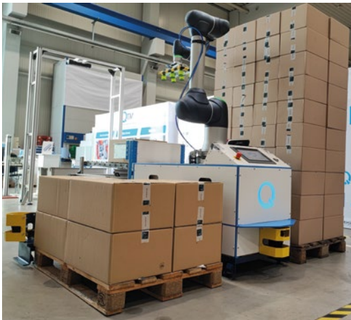
Unipal stapelt Pakete bis 22 kg Gewicht und 2.200 mm Palettierhöhe mit bis zu 360 Paketen pro Stunde.
