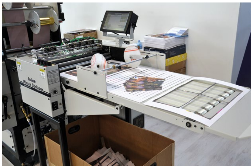
Der „Inline Waste Stripper“ von Therm-O-Type ist eine Ausbrechmaschine, die Stanzabfälle automatisch in eine Abfallbox ausschleust.
