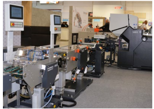
Kleinstfaltungen mit der M9 von H+H (rechts) samt peripherer Weiterverarbeitung. Die Fähigkeit der Maschine, Kreuzbrüche per Messerfals auszuführen, ist patentiert.
