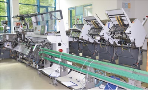
So sieht also ein Heidelberg Stitchmaster ST450 aus, wenn PPL ihn zur Prüfung und Überarbeitung in seine einzelnen Komponenten zerlegt.
