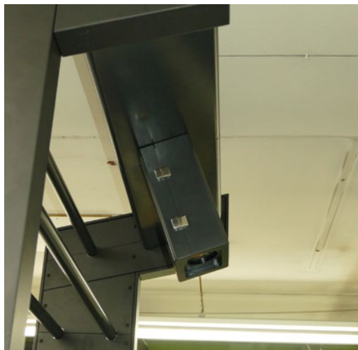
Das PQA-S-V5-Kamerasystem für die Inline-Qualitätsinspektion und die Inline-Farbmessung und -regelung sowie die automatische Registersteuerung.
