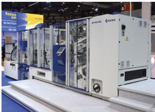
Die Schachtelmaschine BLF 500 mit Eckenstanze BLP 500 aus der Boxline-Maschinenserie für Premiumverpackungen.
