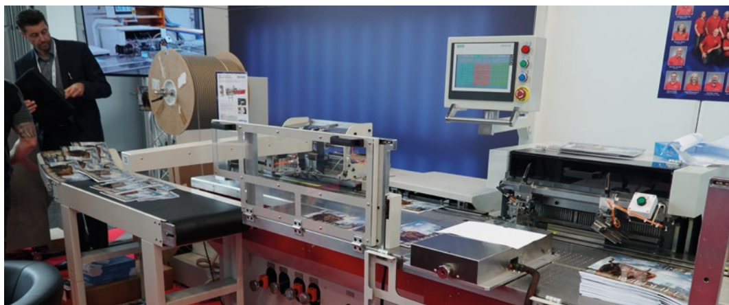
Die Magnopro Bind 580 S wird inklusive einer Bandauslage geliefert. Sie ermöglicht die automatische Schuppenauslage inline oder in einem 90-Grad-Winkel. Die Taktzahl der Maschine liegt bei 1.500 Stück pro Stunde.
