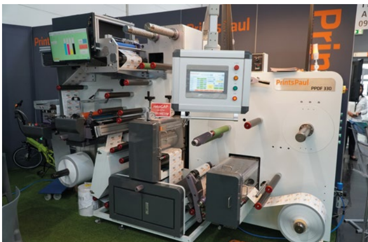
Der kompakte PPDF 330 ist bei PrintsPaul-Kunden überaus beliebt und auch als PPDF 420 mit bis zu 420 mm Bahnbreite verfügbar. Neu ist die Möglichkeit, ein Vierfarb-Inkjetmodul (hier links oben) zu integrieren..
