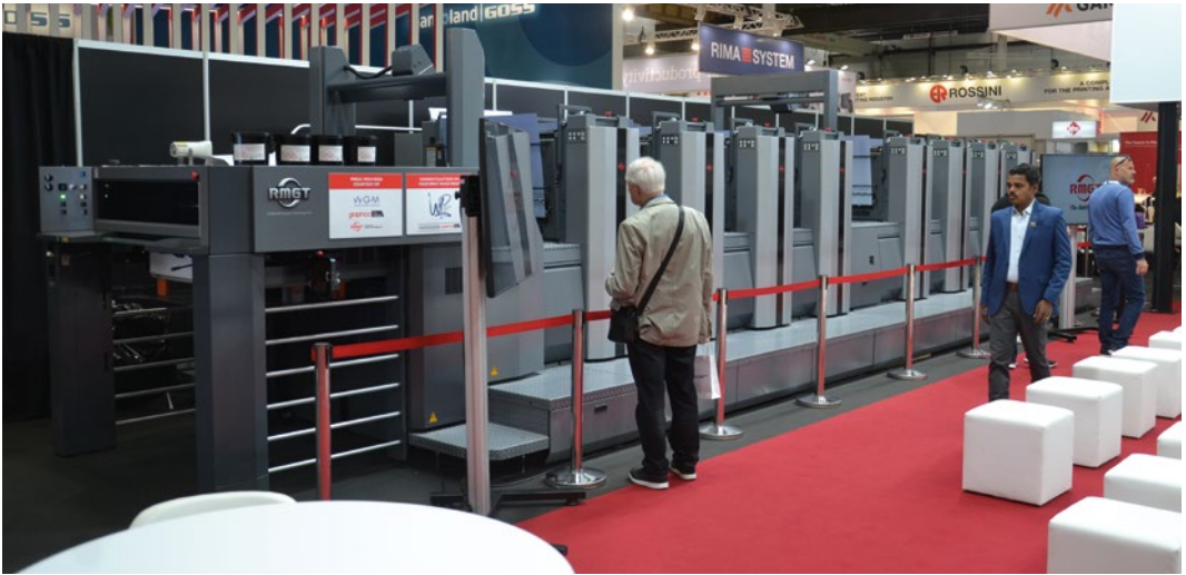
Im Bereich Akzidenzdruck stand die RMGT 970PF-8 als Achtfarben-Perfektor im Mittelpunkt. Der aktuelle Topseller von Ryobi im A1-plus-Format demonstrierte seine fortschrittlichen Automatisierungsfunktionen.
