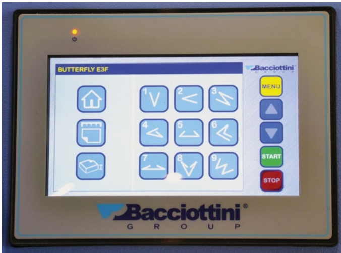
Das vereinfachte HMI-Panel von Bacciottini, das es auch ungelerntem Personal schnell ermöglicht, die butterfly Rill-/Falzmaschinen zu bedienen.
