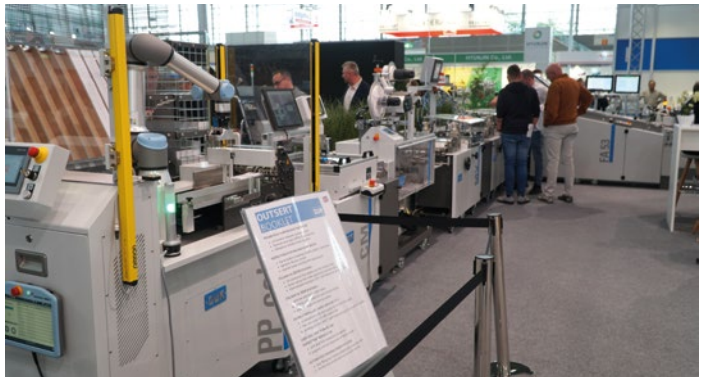
...demonstrieren dies mit dieser automatisierten Outsert-Produktionslinie auf Basis des FA53-Multitaschensystems (im Hintergrund).
