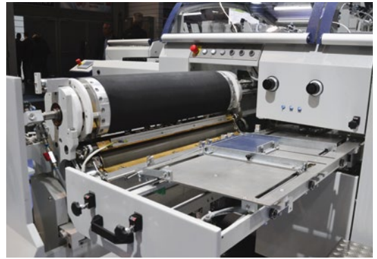
Björn Dieckmann, Anwendungstechniker bei Kolbus, beim Einrichten eines Auftrags auf der neuen Buchdeckenmaschine DA 160 für eine Kunden-Demonstration während der drupa 2024 in Düsseldorf.
