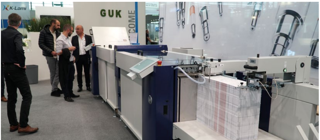
Der neue Hochleistungsfalzautomat FSA 52/85-Net von MB Bäuerle verfügt über einen Flachstapelanleger mit Net-Steuerung und Ultraschall-Doppelbogenkontrolle sowie einen automatischen Ausrichtetisch.
