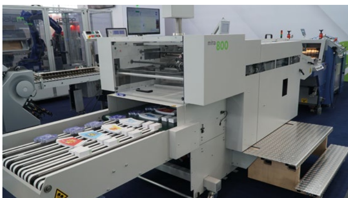
Die automatische Einzelbogenauslage mitra kann verschiedene Produkte gleichzeitig sammeln, stapeln und ausgeben, so wie sie aus der hier vorgeschalteten Bograma-Stanzmaschine übergeben werden.
