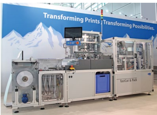
Mit der fastCut & Pack lassen sich Fotodrucke in Hochgeschwindigkeit automatisiert schneiden und verpacken.
