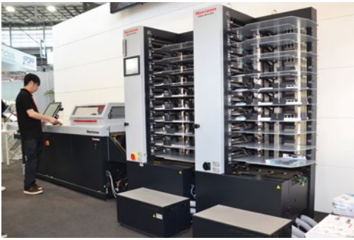
Der iCE Stitcher SPF-2000 kann für Digital- und auch Offset-Workflows konfiguriert und mit iCE LiNK, dem cloudbasierten Workflow-System von Horizon, verbunden werden.
