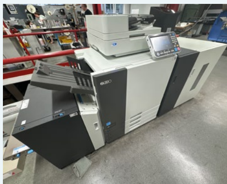
Die Riso ComColor GL 9730 bei Kemna ist mit einem Scanmodul ausgestattet.
