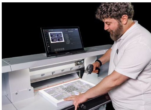
Einlesen des Schnittprogramms für den THE 56 durch Scannen des abgedruckten QR-Code auf dem Deckblatt.
