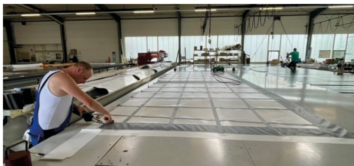
Einer der Arbeitsschritte in der LKW-Planen-Herstellung ist das Aufschweißen der Verstärkungen.
