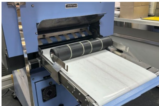
Bereits im Frühjahr 2023 installierte binderhaus die erste Rill- und Falzmaschine OXO Multiskill bei Bühler, deren Leistung von bis zu 9.000 Bogen/h überzeuhte. Vier Monate holte man sich eine zweite, identische Maschine ins Haus.
