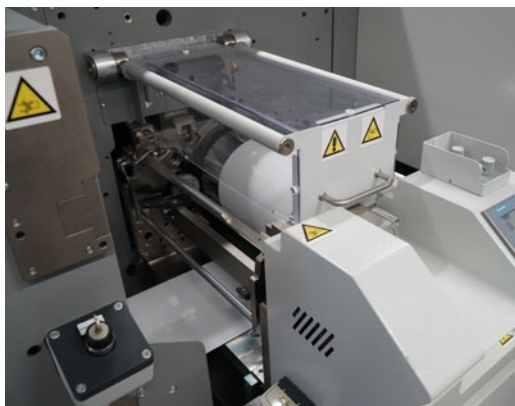
Das vorgeschaltete Flexodruckwerk kann sowohl zum Primern als auch für Sonderfarben und Metallic-Effekte verwendet werden. Weitere Flexomodule sind möglich.
