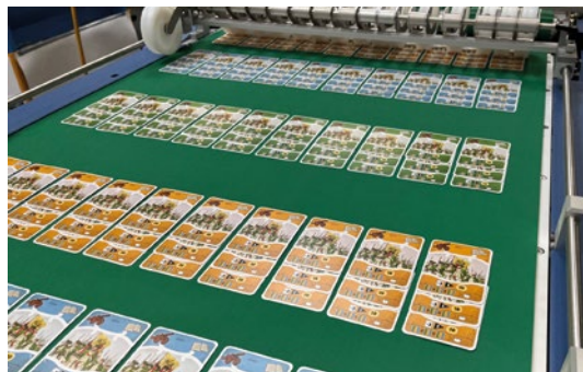
Die neue rotative Stanzmaschine BSR 750 für den Formatbereich B1 als Teil einer automatischen Spielkartenproduktionsanlage bei Media Gold in Krakau, Polen. Rechtes Bild: Schuppenstrom-Zuführung zur neuen ACC 750 DHS.
