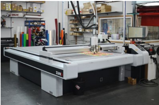
Der große Bruder des S3 bei insign-media: der Zünd G3 L-3200 zum Schneiden und Fräsen schwerer Materialien.
