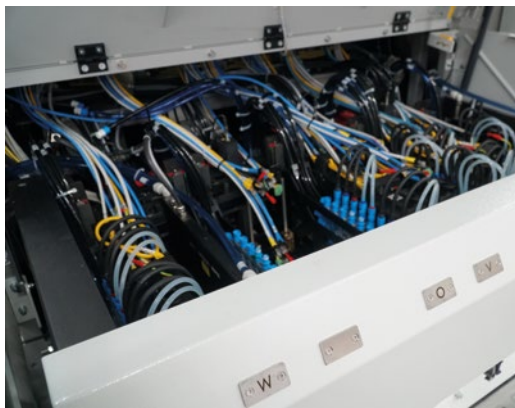
Die Inkjet-Druckeinheit der Bobst Digital Master 340. Aktuell ist sie mit vier Farben plus Weiß ausgestattet, kann aber auf sechs Farben erweitert werden.
