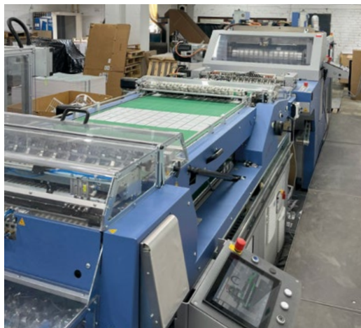
Die neue rotative Stanzmaschine BSR 750 für den Formatbereich B1 als Teil einer automatischen Spielkartenproduktionsanlage bei Media Gold in Krakau, Polen. Rechtes Bild: Schuppenstrom-Zuführung zur neuen ACC 750 DHS.
