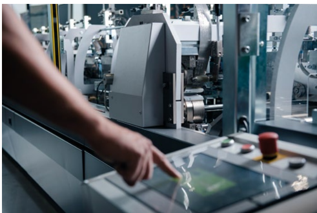
Anwenderfreundlich: Ein Tip am Bedienpult und die FlexFold 52i stellt automatisch zum Format des nächsten Auftrags um.
