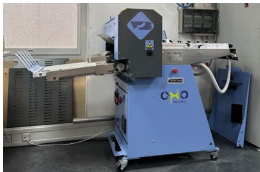
Bereits im Frühjahr 2023 installierte binderhaus die erste Rill- und Falzmaschine OXO Multiskill bei Bühler, deren Leistung von bis zu 9.000 Bogen/h überzeigte. Vier Monate holte man sich eine zweite, identische Maschine ins Haus.
