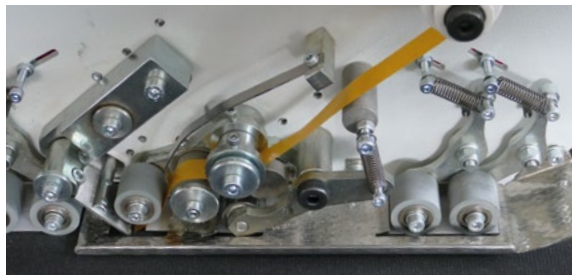
Die präzise Mechanik der APR Athos Plus appliziert bei MTD bis zu 80.000 Doppelklebestreifen pro Tag auf Verpackungen.
