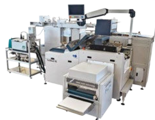
Layflat Buchbindesystem fastBlock 06 Bogen für industrielle Fertigung mit hoher Auflage
