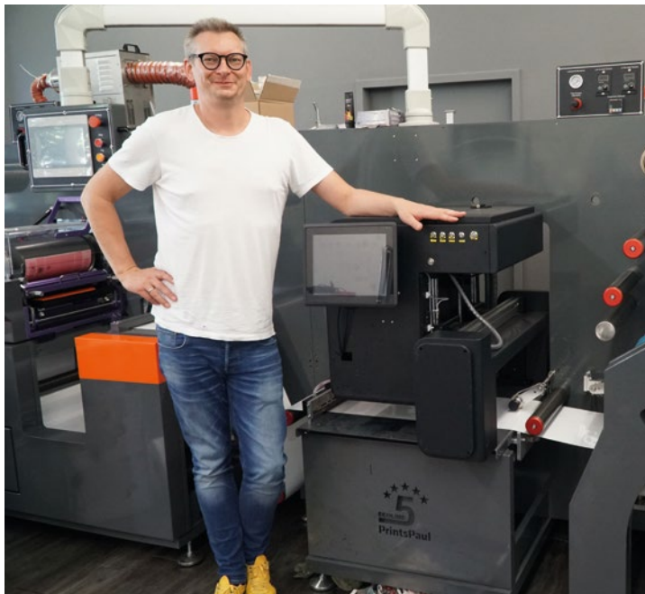
Paul Arndt, hier vor dem Standardmodell PPDF, hat alle seine Maschinen zusammen mit seinem Team selbst entwickelt. Das Inkjetmodul ist hier mittig zu sehen, kann aber auch an anderen Stellen des Frames positioniert werden.
