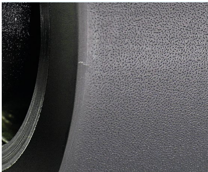
Abbildung 1: „Orangenhaut“-Effekt: Chemische Angriffe, beispielsweise durch Farben und Feuchtmittelzusätze, können zu einer solchen Oberflächenstruktur auf der Walze führen – schlecht fürs Druckergebnis.
