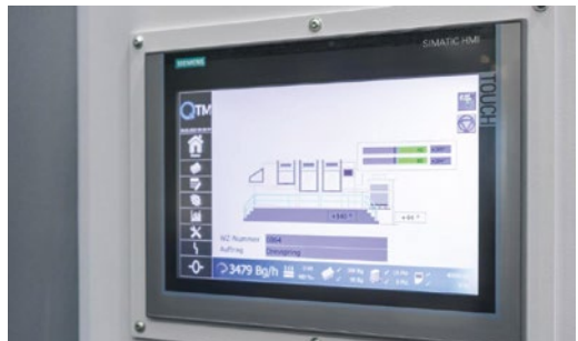
Das von QTM entwickelte Touchdisplay dient zur Auftragsverwaltung und Einstellung von Maschinendaten.
