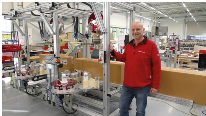
Armin Müller heißt der Fertigungsleiter, der auch für den äußerst sauberen und ordentlichen Zustand der Produktionshalle verantwortlich zeichnet. Er steht hier an einer Kraus-Linie mit sechs Etkettierern (LabelJacks) für eine große Spedition.
