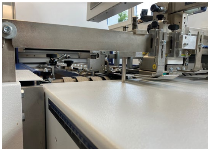
Einfach einzurichten und tausendfach bewährt: der schnelle und zuverlässige Vaculift-Flachstapelanleger an der MBO T50.
