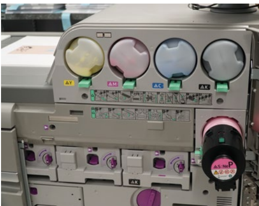
Die fünfte Farbstation bietet nicht nur einen erweiterten Farbraum, sondern mittels Spezialtoner auch viele Veredelungsmöglichkeiten.
