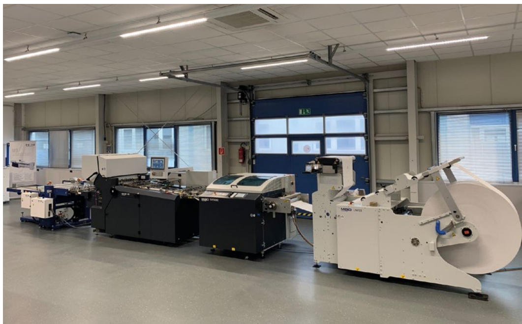
Moderne, vor allem aber wirtschaftliche Verarbeitung von Kleinstformaten von der Rolle: Das Taschenfalzsystem M9 aus dem Hause H+H wird in Kombination mit Unwinder UW23 und Querschneider SVC23 von MBO gezeigt.
