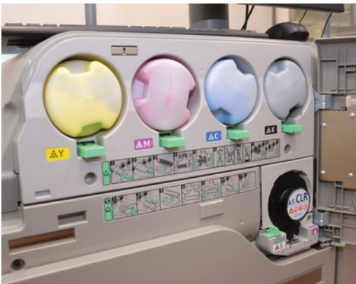
Blick auf die Tonerkartuschen der Ricoh C7500 samt Sonderfarbe.
