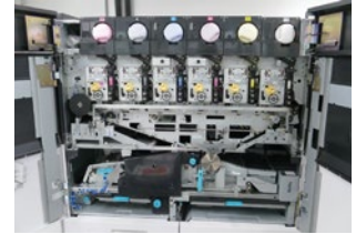
Bis zu sechs Farbstationen sind gleichzeitig online und ermöglichen den Einsatz von Spezialtonern sowie die Erzeugung von Texturen.
