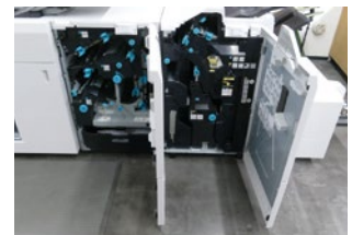
Falzen, Kopf-, Fuß- und Randbeschnitt sowie die Rückstichbroschürenfertigung ermöglichen die Finishing-Aggregate.
