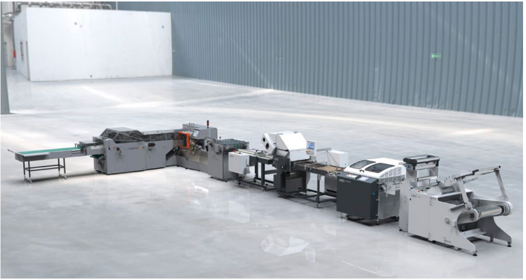
Die HHS-Futura von Hohner in Digitalversion wird in Luzern in Kombination mit MBO Unwinder UW23, Querschneider SVC525C und Falzmaschine DFT23 mit ET407 von H+H im selektiven Verarbeitungsmodus zu sehen sein.
