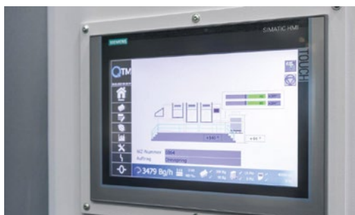
Das von QTM entwickelte Touchdisplay dient zur Auftragsverwaltung und Einstellung von Maschinendaten.
