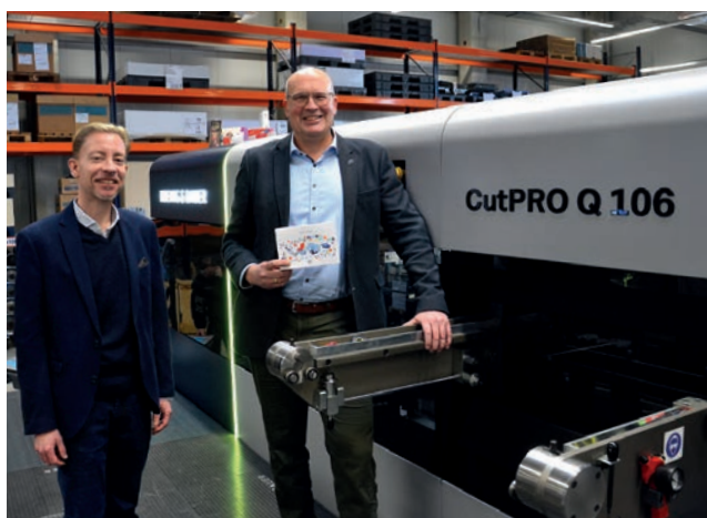
Bernhard Gansert (rechts) erklärt Matthias Siegel von der Grafischen Palette in Radebeul die Vorzüge der Flachbettstanze CutPro Q 106, die mit dem DriveTronic-Anleger der Rapida und dem optischen Bogenanlagensystem Cut2Print arbeitet.
