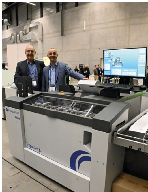
Basierend auf Pitney-Bowes-Kuvertier- und Riso-Drucktechnik bildet der „ExpeJet“ ein kompaktes und dennoch hochleistungsfähiges Druck- und Versandsystem.
