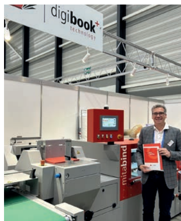
Vertriebsleiter Jens Krüger von Digibook Technology hatte die mitabind im Gepäck, einen automatischen Ein-Zangen-Klebeinder für digital gedruckte Hardcover und Softcover-Bücher in Kleinauflage.
