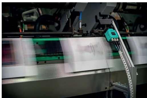
PPL Eagle, seitlich angebracht an der Sammelkette.
