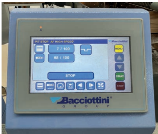
Der Bediener steuert die Balkenrillmaschine der Bacciotini Group intuitiv über ein farbiges 7-Zoll-Touchscreen-Panel.
