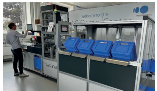
fastCut & Pack, das Hochgeschwindigkeits-Schneide-/Verpackungssystem für Fotodrucke von Imaging Solutions.
