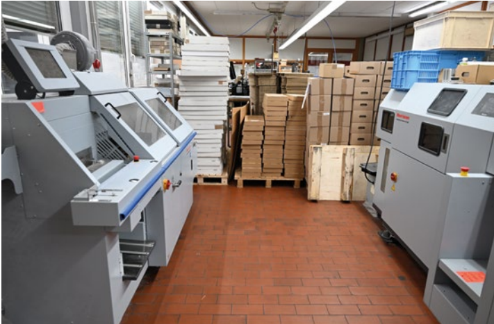
Der Ein-Zangen-Klebebinder Horizon BQ-270V (li.) wurde 2016 zusammen mit dem Dreiseitenschneider HT-30C in Mellrichstadt installiert und deckt seither die Produktion von klebegebundenen Broschüren bis Auflage 1.000 ab.
