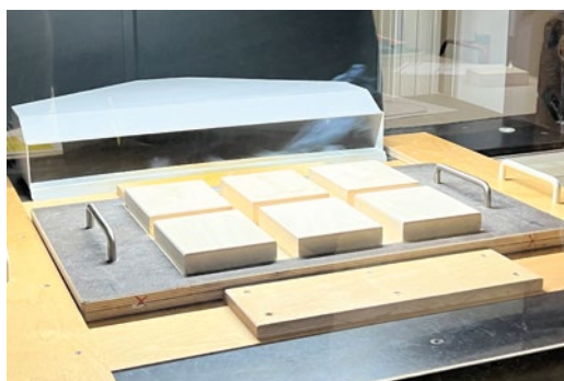
Ein Tray lässt sich mit sechs Bilderboxen bestücken, die dann im Statik-Modus des Motioncutter graviert werden.
