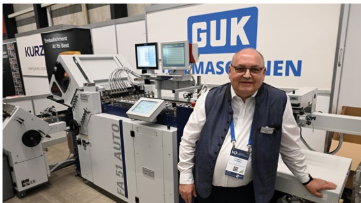
GUK-Geschäftsführer Friedrich Faulhaber vor der hochautomatisierten Falzlinie, die bei den Hunkeler Innovationsdays unter anderem mit Inspektionssystem, Etikettiereinheit und PPcobo-Stacker in Aktion zu sehen war.
