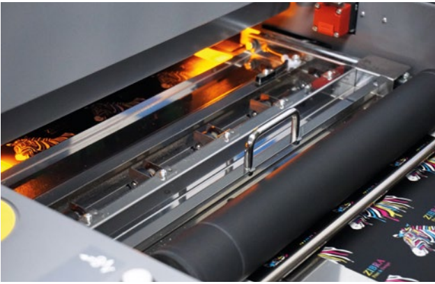
Das Barcode-Kit der DuSense DDC-810 Pro: Barcodes sind auf jedem Bogen lesbar, die jeweilige Lackdatei wird automatisch geladen.
