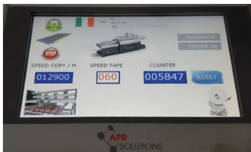
Aufspendemaschine Athos Plus für doppelseitiges Klebeband und Aufreißband von APR Solutions, samt Bedienfeld.
