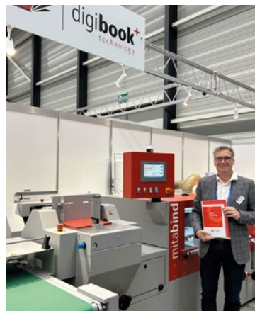
Vertriebsleiter Jens Krüger von Digibook Technology hatte die mitabind im Gepäck, einen automatischen Ein-Zangen-Klebeinder für digital gedruckte Hard- und Softcover-Bücher in Kleinauflage.
