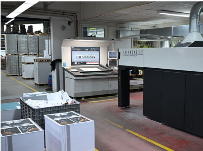
Den Drucksaal beherrschen die beiden IIIb-Fünffarben-Bogenoffsetmaschinen Komori Lithrone LS40 und G537 (hier im Bild), die auf das Plattenmaterial-sparende Format 65 x 92 cm ausgelegt ist.
