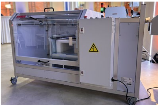
Universelles Auslagesystem BAS70, optimiert für die Kopplung an die automatischen Schneidplotter der Sinajet DF-Serie.
