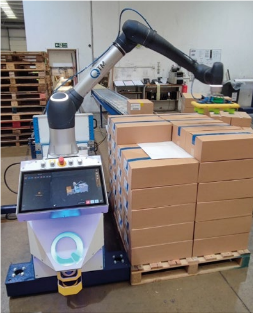
Ein Unipal bei der Arbeit. Das mobile Robotermodul ist hier beim Palettieren zu sehen. Das Bild entstand während einer Roadshow in Großbritannien.
