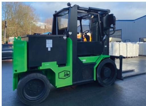
Einer von zwei Elektro-Schwerlaststaplern von Aribas. Damit lassen sich auch schwierige Fahrmanöver in engen Drucksälen abgasfrei bewältigen.
