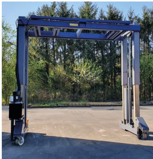
16 Tonnen hebt dieser mobile Portalkran – unverzichtbar, wenn Aggregate in niedrigen Hallen bewegt werden müssen. Übrigens vermietet Aribas den Kran auch.
