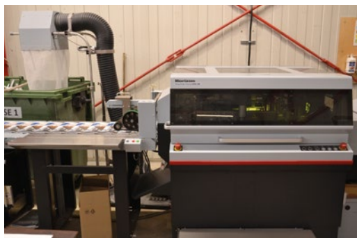
Hochpräziser Dreiseitenschneider HTS-50 für den Endbeschnitt der auf dem StitchLiner Mark V produzierten Broschüren.
