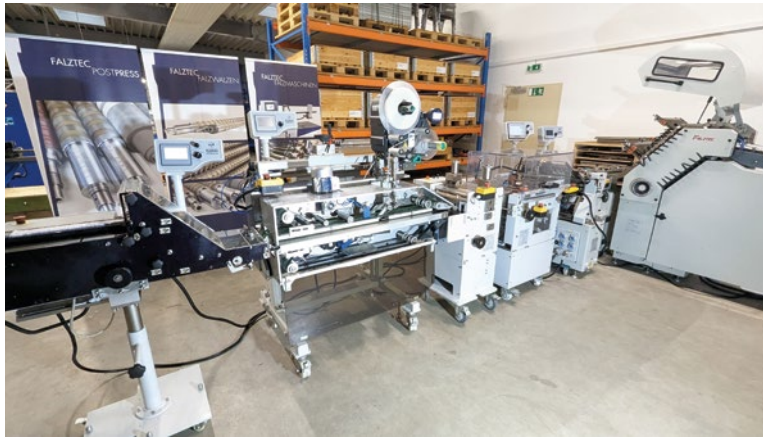
Outsert-Produktion mit der Superfold RPF 53. Integriert in die Produktionsstraße ist der neue Pratham Super Double Tabber, der jetzt mit bis zu 50 m/s verschlussetikettiert.
