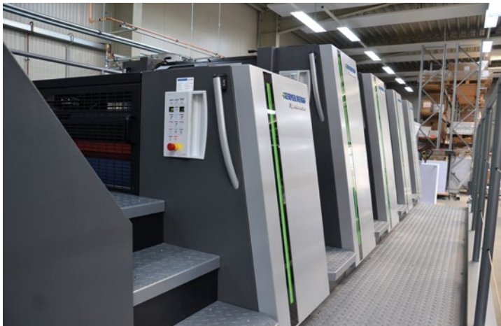
Heidelberg Speedmaster XL75-4+L: Mit ihrem Lackwerk sind jetzt Veredlungsschritte möglich, für die zuvor aufwendig „um die Ecke“ gedacht werden mussten.
