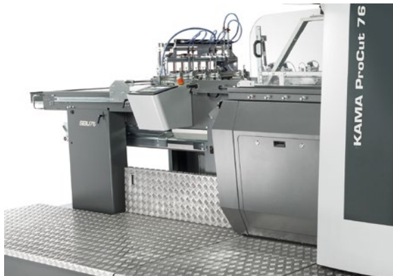
Das automatische Ausbrechsystem an der ProCut 76 benötigt keine Werkzeuge und reduziert Kosten und Arbeitszeit.
