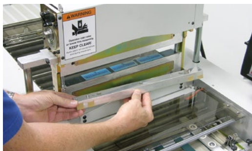
Station für das Prägen, Stanzen, Lochen und Eckenrunden.
