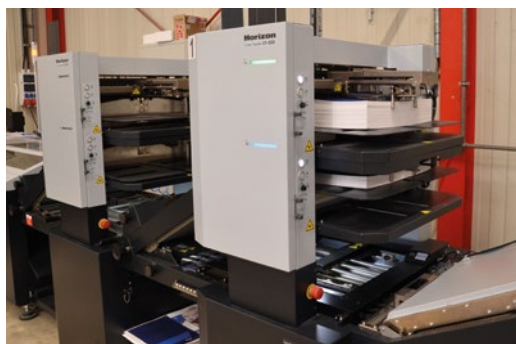
Bis zu drei Umschläge oder Einlegeblätter flexibel zuführen – mit dem Horizon Cover Feeder CF-50D.
