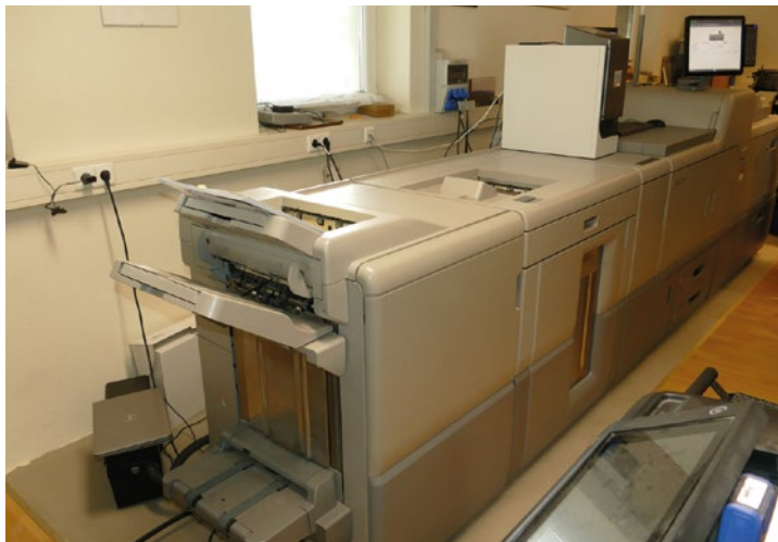
Die Ricoh Pro C7200x von NKS Nothnagel mit Broschürenfertigung setzt bei Schuwert auch Weiß und Klartoner ein. Eine Buffer Pass Unit sorgt für nötige Antistatik.
