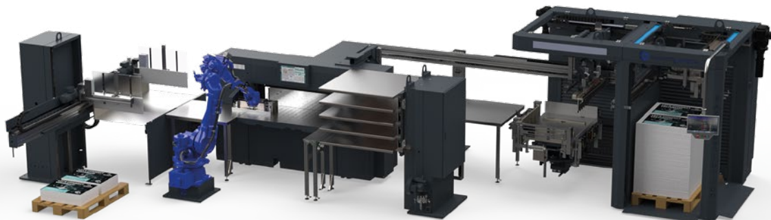
Independent Cutting System für den Akzidenzbereich aus dem Hause baumannperfecta bestehend aus BASA evolution, Schneidemaschine mit Robotic Cutting RC, Stapelpuffer BVP und Ablader BA 3.
