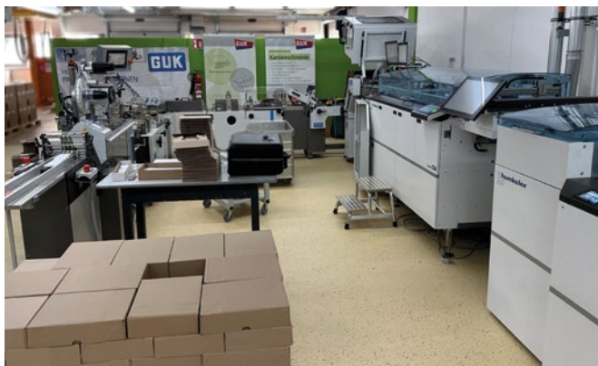
Die brandneue Inline-Falzanlage GUK FA53 AT bei den Pharmadruckern in Melsungen ist ausgestattet mit Abwickler- und Querschneideaggregaten aus dem Hause Hunkeler (Wikon/Schweiz).
