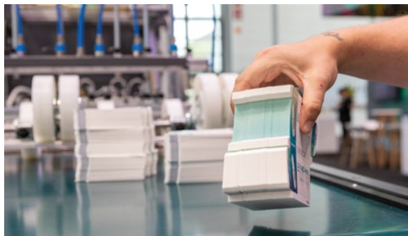
Faltschachtelzuschnitte ohne Haltpunkte, inline separiert an der ProCut 76 mit SBU.
