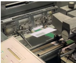
Schnelle Produktion: Bis zu 5.000 bedruckte Kuverts pro Stunde sind möglich.
