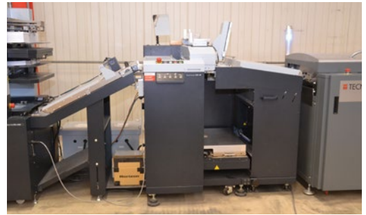
Der Highspeed Sheet Feeder HSF-50 ermöglicht die Zuführung von Einzelbogen mit bis zu 45.000 Bogen/h (A4-Querzug) und erlaubt einen schnellen Wechsel zwischen Rollen- und Einzelblattzuführung für maximale Flexibilität.
