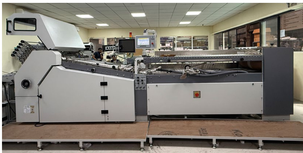
Pharmazeutische Outsert-Produktion bis 72 cm Arbeitsbreite – mit der neuen Pratham Superfold RPF 72/12 mit Rundstapelanleger (rechts), am deutschen Markt künftig vertrieben von der Falztec GmbH.
