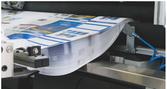
Air-Knife-Technologie zum Belüften der Lagen im Schüttelprozess.
