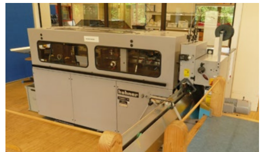
Nur noch Backup: Auch die Hohner-Heftmaschine Exact Plus mit Trimmer T3 wurde von Hand bestückt.
