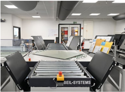
Ein Drehteller steuert die Weiterleitung der Platten an den korrekten Plattentransportwagen.
