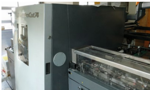
Seit 2009 ersetzt der Kama-Stanzautomat ProCut 74 den ausgedienten Cylinder. Ein Schritt zur Automatisierung.
