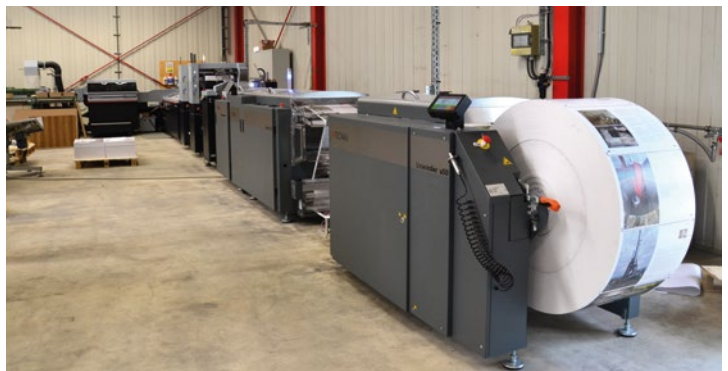
Die Broschürenfertigungsanlage im Gesamtüberblick. Im Vordergrund: das Abrollmodul Unwinder u50 von Tecna.
