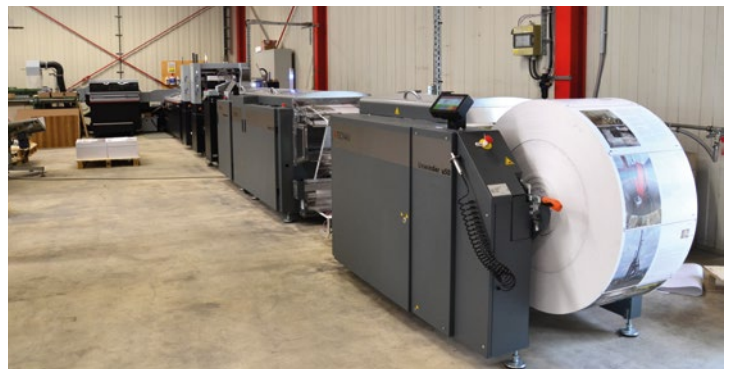
Die Broschürenfertigungsanlage im Gesamtüberblick. Im Vordergrund: das Abrollmodul Unwinder u50 von Tecna.
