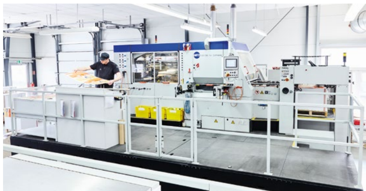
Die Gietz FSA 1060 Foil Commander wird bei Gräfe für den Prägetransfer eingesetzt.
