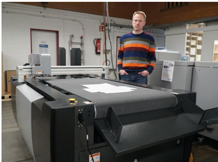
Da kann Geschäftsführer Tobias Kötter entspannt die Hände in den Hosentaschen lassen: Die Magnopro i-Cut 1007 Plus produziert vollautomatisch und auch über längere Zeit ohne einen Bedienereingriff.
