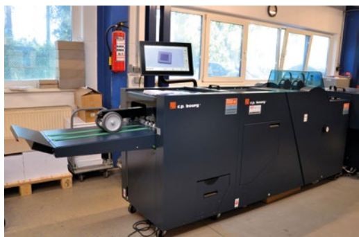
Das Zuschnittsmodul und das Herzstück, das BM-e-Broschürensystem en bloc im Druckraum in Cottbus.
