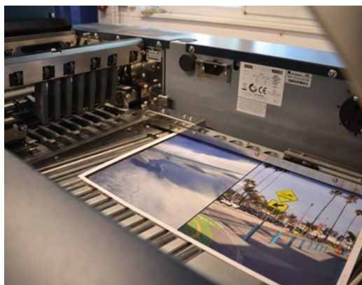
Der fertige Bogen wird im BPM direkt zur Weiterverarbeitung vorbereitet.
