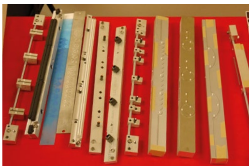
Verschiedene Werkzeuge (von links): Taktperfo, Rillen, Blindprägen, Rillen, Lochen, Konturstanzen, Lochstanzen und Kreissegment-Laschenstanzen.
