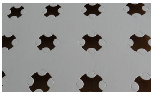
Filigrane Ausbrechungen und Anstanzungen, wie hier bei den Halterungen für Konfekt-Kugel-Einsätze, sind mit den Stanz- und Rillblechen in der BSR 550 Servo möglich.
