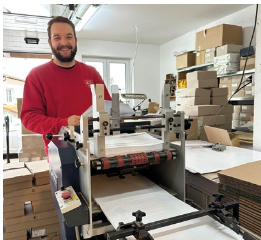
Geschäftsführer Philipp Eßer prüft jeden Auftrag in Abstimmung mit den Druckern. Dabei helfen Wahl- und Stream-Feeder an der Anlage.
