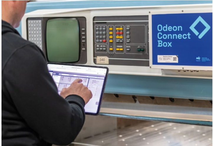
Datenerfassung an alter Technik durch die Odeon Connect Box.
