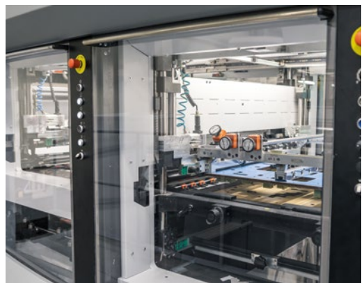
Die von QTM entwickelten Schnellspannrahmen ersetzen bei GPI die Originalausrüstung der Dymatrix, sorgen für kürzere Rüstzeiten und sichere Ersatzteilverfügbarkeit.
