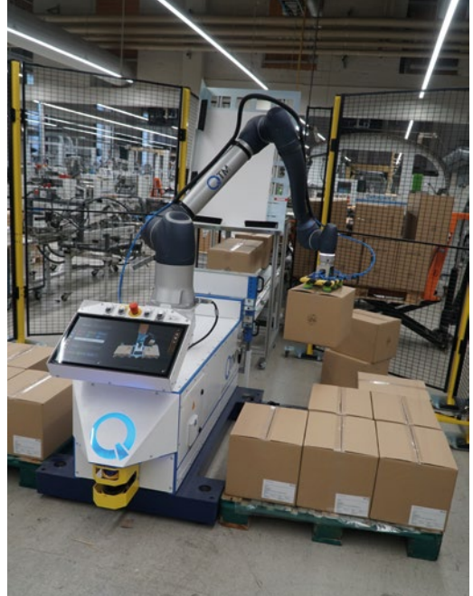
Unipal S lässt sich per Touchscreen in Sekunden auf andere Stapelschemata einstellen und auch an anderen Linien platzieren. Das mühsame manuelle Stapeln entfällt – und sorgt für gute Laune beim Bedienpersonal.
