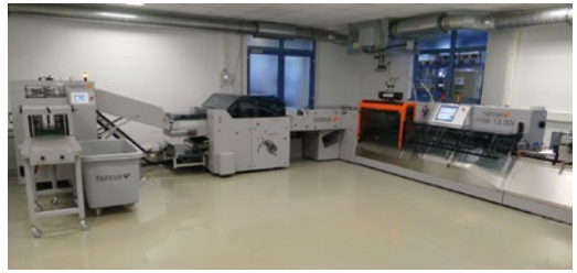
Von rechts: Herzstück der Anlage ist der vollautomatische Hohner-Sammelhefter HSB 13.000 mit Heftstation, gefolgt von der 90°-Riemenübergabe, dem vollautomatischen Trimmer und letztendlich einem Paketkreuzleger.
