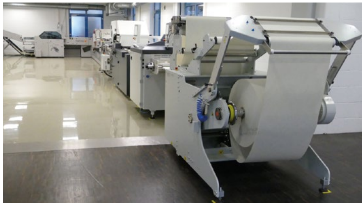
Im Democenter von Hohner als Prototyp „zum Anfassen“ komplett aufgebaut: der HSB Digi 13.000 mit Rollen-, Schneid- und Falzausstattung von MBO.
