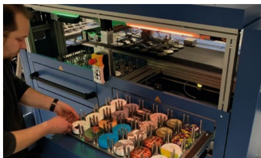
Die neue Next-Level-RBA-550-Mischbogen-Auslage von Bograma basiert auf der Roboter-Einheit von Unimotion. Hier werden 24 gestanzte Einheiten mit einem Hub in außerordentlicher Geschwindigkeit sortiert abgelegt.
