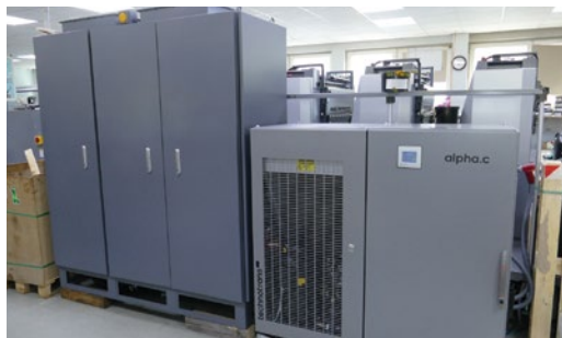
Ein schalldichter Pumpenschrank sowie eine leistungsfähige technotrans-Anlage zur Feuchtmittel-Aufbereitung und Farbwerk-Temperatur ergänzen die RMGT-Installation.
