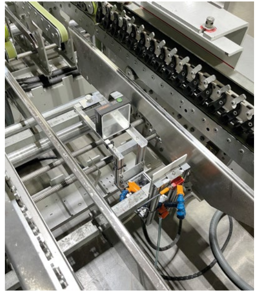
Rattpack: Highspeed-Inspektion beim Faltschachtelkleben mit kvInspect von Kaiser Vision.
