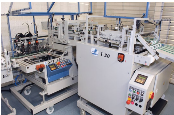
Zur Konzeption einer Broschürenfertigungslinie: das Anschlussaggregat MKW Rapid SFT 350 (Heftung/Falzung/Frontbeschnitt) und die MKW Rapid T20 für den exakten Kopf- und Fußbeschnitt der Broschüre.
