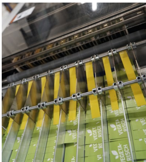
Die 500 mm lange elektrische Bandauslage legt auch Kleinformate sauber und ohne Durcheinanderfallen aus. Sie können ohne Stopp abgenommen werden.
