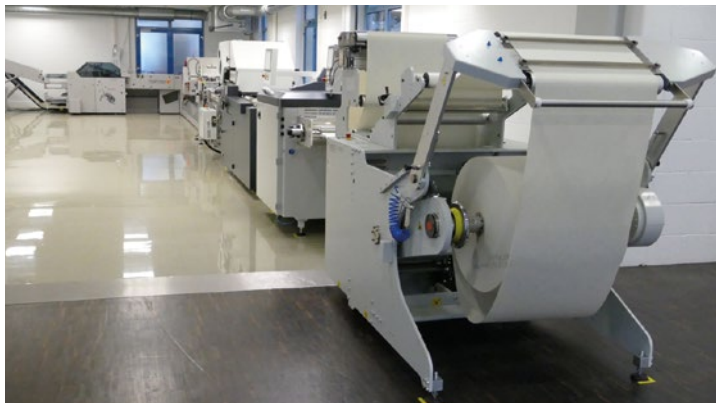
Im Democenter von Hohner als Prototyp „zum Anfassen“ komplett aufgebaut: der HSB Digi 13.000 mit Rollen-, Schneid- und Falzausstattung von MBO.
