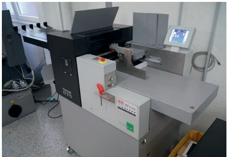
Die FKS/Multigraf Touchline CF375 ist eine Balkenrillmaschine, welche Rill- und Falzarbeiten in einem Arbeitsgang erledigt. Dabei werden Grammaturen bis 400 g/m 2 zuverlässig verarbeitet.
