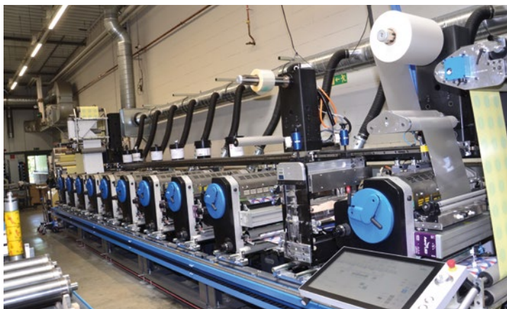
Für die Installation der Gallus Labelmaster waren einige Umräumarbeiten in Meinerzhagen nötig, um Platz zu schaffen. Das modular aufgebaute System mit einer Bahnbreite von 440 mm erreicht Geschwindigkeiten von bis zu 200 m/min.
