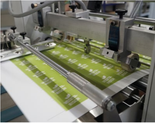
Der Flachstapelanleger verarbeitet Papier und Karton bis zu 400 g/m 2 . Er verfügt über eine akkurate Ausrichtstrecke in voller Bogenlänge.
