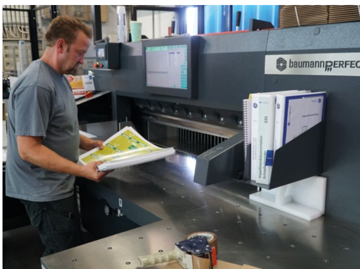
Maschinenbediener Sascha Kaser weiß die Vorteile der neuen Schneideanlage zu schätzen. Besonders der automatische Ablader, der die geschnitten Pakete auf Paletten setzt, vermeidet nachteilige Bewegungen und erleichtert die Arbeit.
