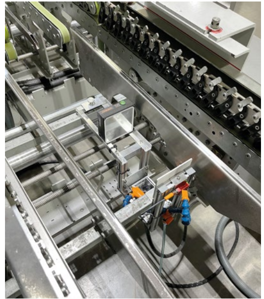
Rattpack: Highspeed-Inspektion beim Faltschachtelkleben mit kvInspect von Kaiser Vision.
