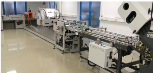
Danach geht es über einen Überleittisch, die Rill-/Falzeinheit und die Sammeleinheit zum Umschlaganleger.
