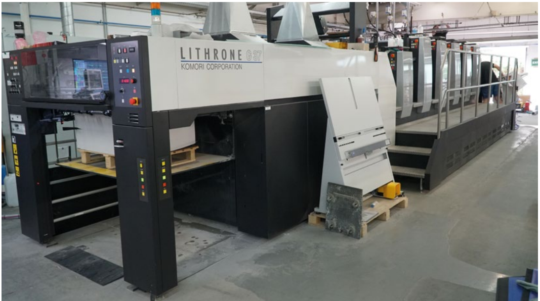
Die Lithrone G37 ist das mittlere Modell aus Komoris G-Serie und druckt bis zum Format A1. Durch die maximale Bedruckstoffdicke von 0,8 mm eignet sie sich für den Verlags- und Akzidenzdruck wie auch für den Verpackungsdruck.
