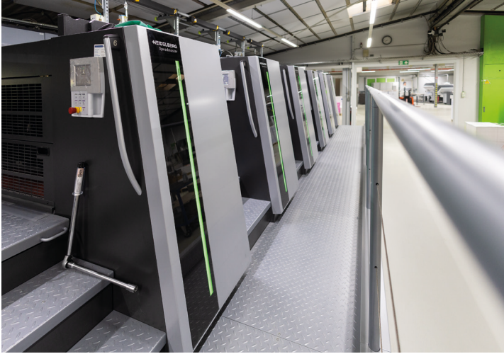
Die Push-to-Stop-Achtfarben-Speedmaster XL wird künftig von der Rolle mit Papier bestückt. Dafür wird ein CutStar installiert.
