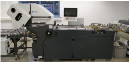
Gefalzt wird mit der mobilen Falzstation DFT23 von MBO.
