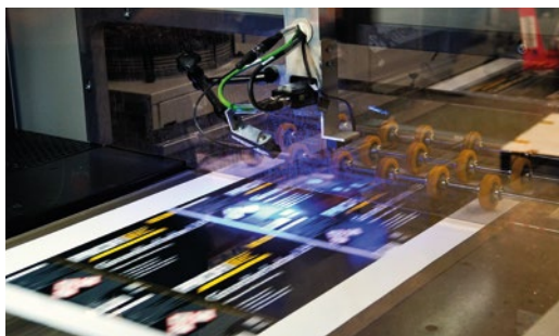
Ein Kamerasystem triggert jeden Bogen, Toleranzen im Digitaldruck werden so erkannt und ausgeglichen.
