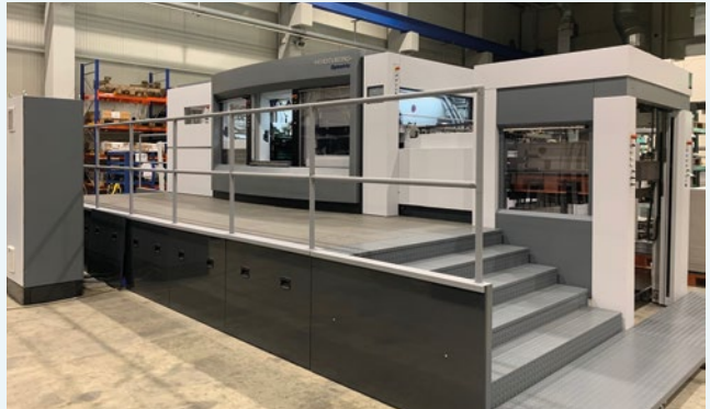
Von QTM überarbeitete und erweiterte Dymatrix-Stanze von Heidelberg.
