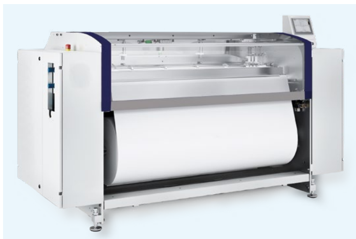
Nutzenschneider KS 601 von Kolbus: materialschonender Zuschnittsprozess.
