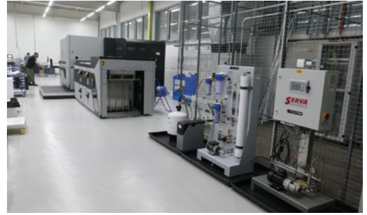
Die Wasseraufbereitungs- und Steuerungs-Anlage steht in der Druckhalle – im Hintergrund eine HP Indigo 120K.
