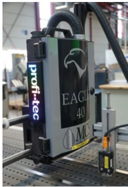
Das Eagle-40-System verarbeitet auch wasserbasierende Tinte.
