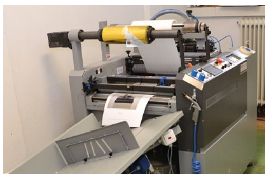
Die FKS/Komfi Amiga 52 beherrscht neben Folienkaschierung auch die Übertragung metallisierter Folien.
