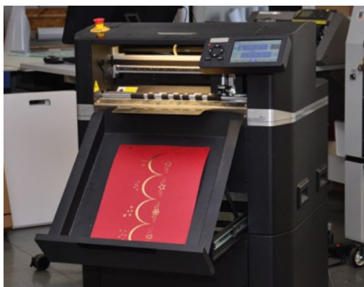
Läuft seit Mitte 2025 bei DDH in Hilden: der digital gesteuerte Stanzvollautomat Morgana SC7000 Pro-T.
