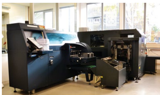
Der FKS/C.P. Bourg BB3002 EVA, bei dem der CMT-330 den Drei-Seiten-Schnitt direkt im Anschluss übernimmt.
