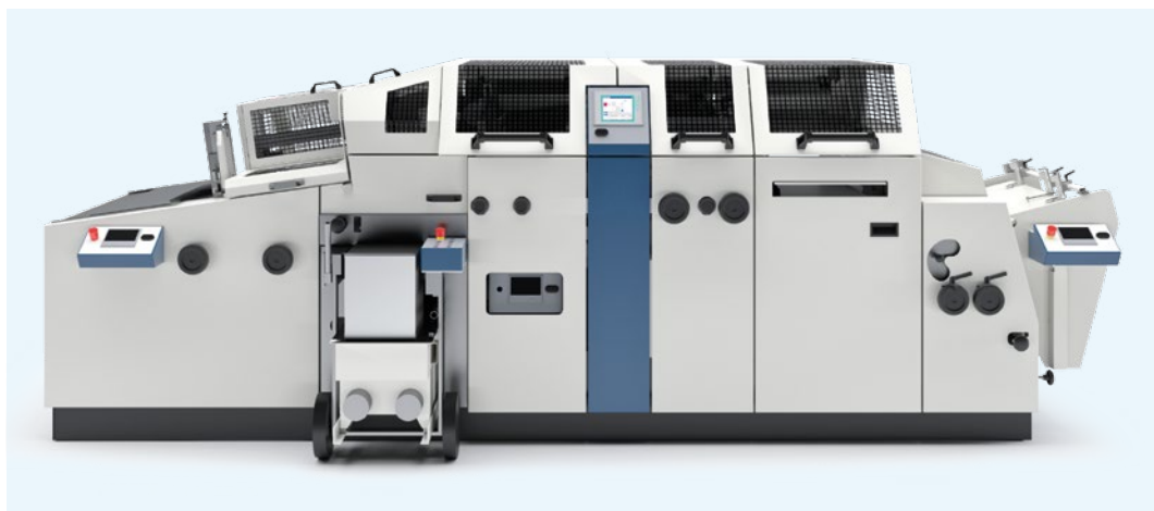
Moderne und vielseitige Deckenmaschine DA 260 von Kolbus: vollautomatische Verarbeitung von Pappen und Nutzenmaterial zu Buchdecken, Mappen oder Kalenderrücken mit bis zu 40 Takten/min.
