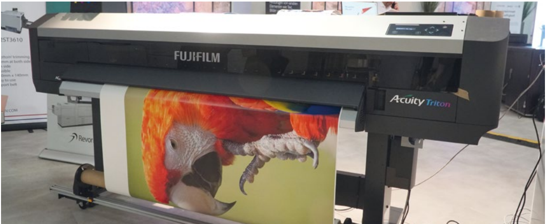
Auch eine Premiere hatte der Crefelder Cocktail zu bieten: Der brandneue Acuity Triton ist ein 1,6 m breiter Drucker mit einem einzigartigen Druck-/Trocknungsverfahren, das wasserbasierende UV-Farben verwendet.
