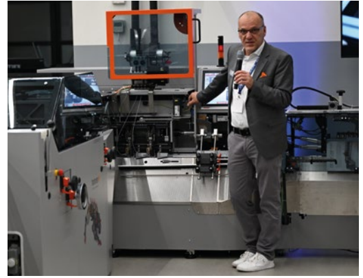
Sascha Schmidt, Head of Sales bei Hohner Maschinenbau, stellte den hybriden Sammelhefter HHS-Futura vor, der das Herzstück einer Inline-Produktionsstrecke für digital verarbeitete Broschüren mit Rückstichheftung bildete.
