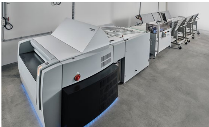
Kompakt und leistungsstark: Der CPL 106, hier rechts hinter dem Suprasetter, erlaubte eine platzsparende Aufstellung der Druckplattenstraße und völlige Automatisierung der Druckplattenproduktion ohne manuelle Eingriffe.
