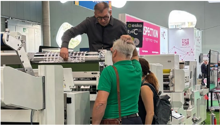
Paul Arndt erläutert einem Messebesucher auf der Labelexpo in Barcelona die Funktion des servogesteuerten Matrixabzugs. Das Konzept war eines der Messe-Highlights und wird von PrintsPaul künftig auch für kleinere Modelle angeboten.
