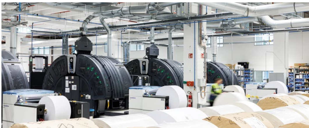
Im Rolleninkjetdruck bei Libri kommen HP-Systeme zum Einsatz. Druck und Weiterverarbeitung erfolgen inline bis zum vorverklebten Buchblock.
