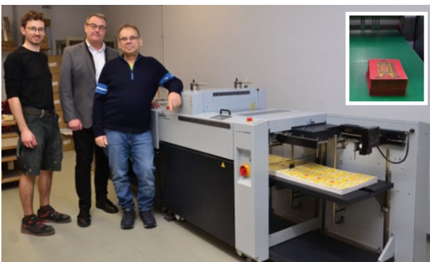
Von links: Produktionsleiter Daniel Rempel, Roland Stoeber (Key Account Manager, Horizon) und Inhaber Peter Hantschel vor der rotativen Stanze RD-N4055DM. Rechts im Bild der Magnetzylinder der Maschine zur Aufnahme der Stanzbleche.
