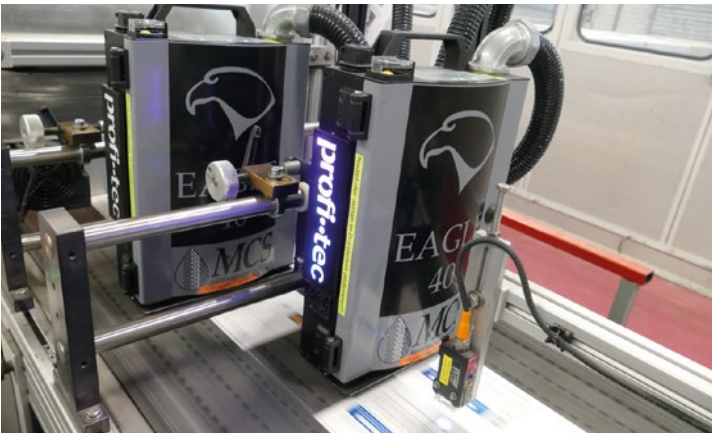
Zweitens: ein mobiles System, auch mit Hybrid-Köpfen, jedoch 2 x 4,25" (à 108 mm) als Standalone-Lösung auf einem mobilen, fahrbaren Vakuumdrucktisch.
