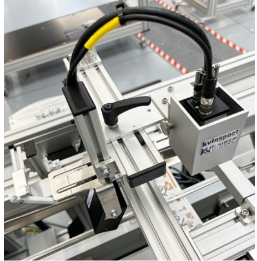
Die Inspektionssystemlösung kvInspect im Einsatz an einer Kraus-Zusammentraglinie für Leaflets und Booklets.
