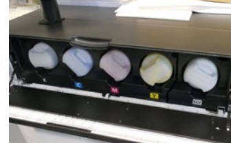
Die fünfte Farbstation ist bei Blumenstiel gern mit Silber belegt. Gold wird derzeit eingetestet.
